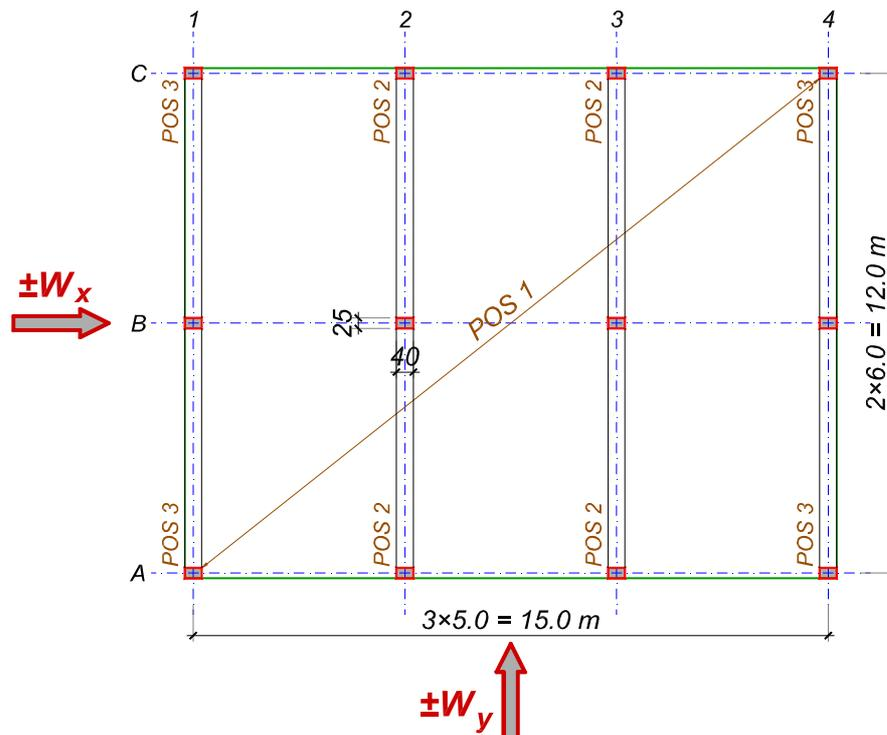
Na skici je prikazana osnova jednospratne armiranobetonske konstrukcije. Ukupna visina konstrukcije od kote uklještenja iznosi  $H = 4.0$  m.
