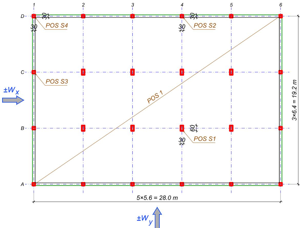
Ploča **POS 1** debljine  $d_p = 20$  cm oslonjena je na stubove POS S1 – POS S4 i ivične grede dimenzija 30/50 cm. Ploča je, pored sopstvene težine, opterećena povremenim opterećenjem  $p = 8 \text{ kN/m}^2$  koje deluje po čitavoj površini. Potrebno je:
