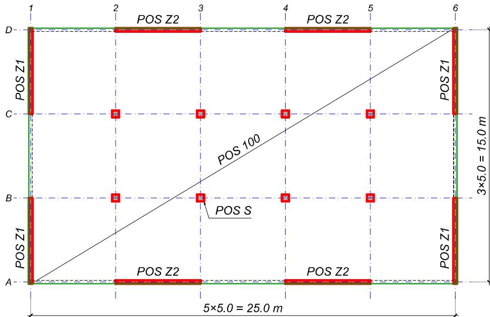
Osnova tipskog sprata poslovne zgrade sa vertikalnim konstruktivnim elementima prikazana je na skici. Spratna visina je 3.5 m, a ukupna visina konstrukcije od kote ukljuštenja iznosi  $H = 8 \times 3.5 = 28$  m (prizemlje i 7 spratova). Nije potrebno razmatrati položaj stepeništa. Međuspratna tavanica je ploča debljine **18 cm** direktno oslonjena na kvadratne stubove i zidove debljine **20 cm** povezane fasadnim gredama. Krovnu ploču tretirati kao tipsku tavanicu.
