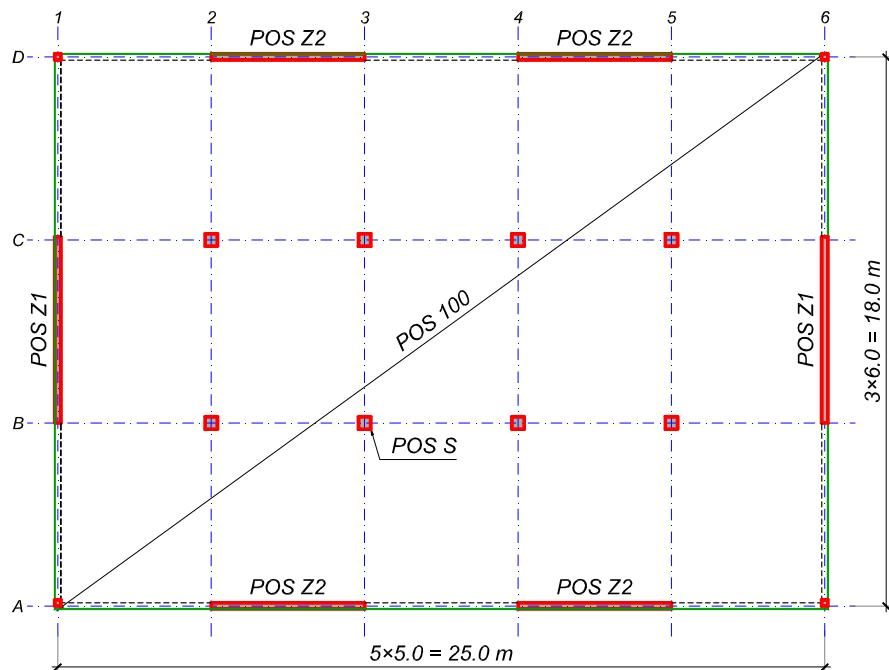
Osnova tipskog sprata poslovne zgrade sa vertikalnim konstruktivnim elementima prikazana je na skici. Spratna visina je 4.0 m, a ukupna visina konstrukcije od kote uklještenja iznosi  $H = 8 \times 4.0 = 32$  m (prizemlje i 7 spratova). Nije potrebno razmatrati položaj stepeništa. Međuspratna tavanica je ploča deblijine **20 cm** direktno oslonjena na kvadratne stubove i zidove deblijine **20 cm** povezane fasadnim gredama. Krovnu ploču tretirati kao tipsku tavanicu.
