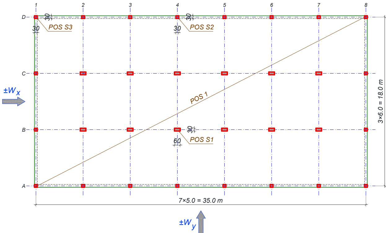
Ploča **POS 1** ( $d_p = 20 \text{ cm}$ ), opterećena je, pored sopstvene težine, povremenim opterećenjem  $p = 10 \text{ kN/m}^2$  koje deluje po čitavoj površini ploče. Oslonjena je direktno na stubove **POS S1**, dimenzija 30/60 cm, odnosno na ivične grede dimenzija 30/50 cm (ose A,D,1 i 8). Grede su oslonjene na ivične i ugaone stubove, dimenzija 30/30 cm. Potrebno je:
