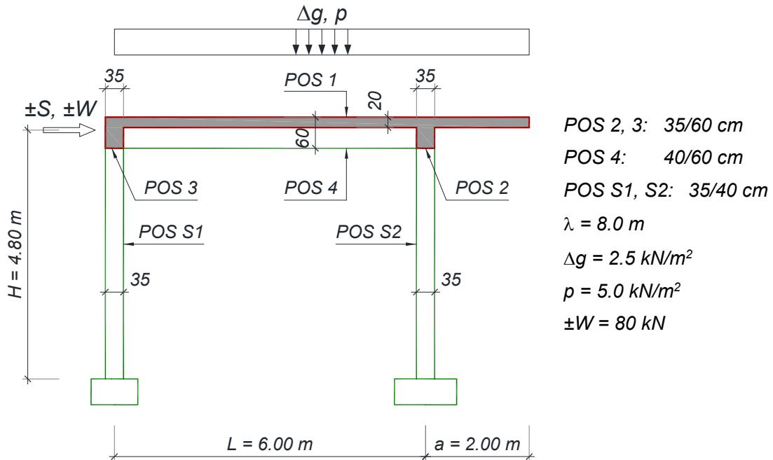
2. Tipska ploča ( $d_{pl} = 20 \text{ cm}$ ) međuspratne konstrukcije **petospratnog** objekta prikazana na skici je oslonjena na kvadratne stubove  $40/40 \text{ cm}$ . Pored sopstvene težine, ploča je opterećena i dodatnim stalnim opterećenjem  $\Delta g = 2.5 \text{ kN/m}^2$  i povremenim opterećenjem  $p = 5 \text{ kN/m}^2$ .
