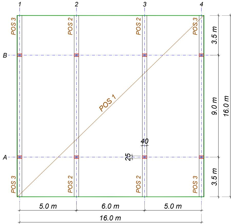
Na skici je prikazana osnova jednospratne armiranobetonske konstrukcije. Ukupna visina konstrukcije od kote uklještenja iznosi  **$H = 4.0 \text{ m}$** .
