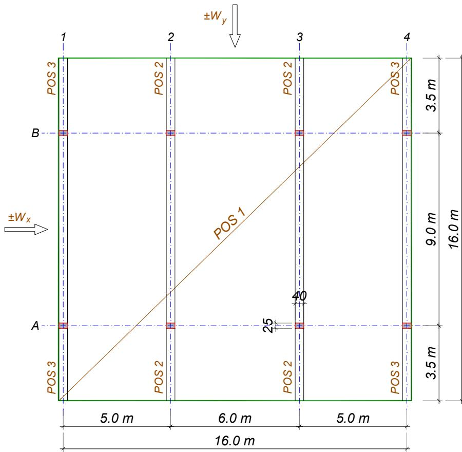
Na skici je prikazana osnova jednospratne armiranobetonske konstrukcije. Ukupna visina konstrukcije od kote uklještenja iznosi  **$H = 4.0 \text{ m}$** .
