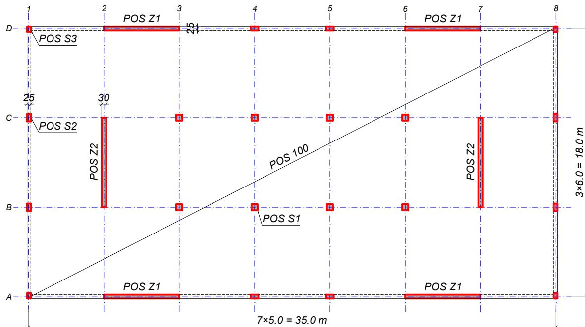
Osnova tipskog sprata poslovne zgrade sa vertikalnim konstruktivnim elementima prikazana je na skici. Spratna visina je 3.5 m, a ukupna visina konstrukcije od kote uklještenja iznosi  $H = 8 \times 3.5 = 28.0$  m (prizmle i 7 spratova). Nije potrebno razmatrati položaj stepeništa. Međuspratna tavanica je ploča debljine 20 cm direktno oslonjena na stubove i zidove (postoje samo fasadne grede). Krovnu ploču tretirati kao tipsku tavanicu.
