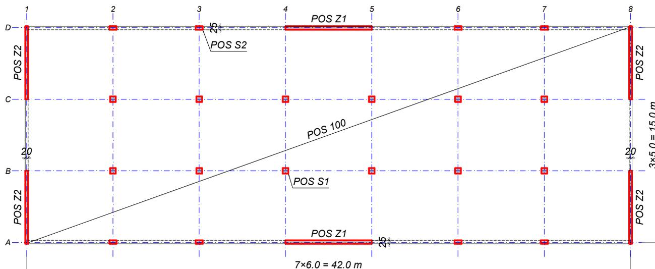
Osnova tipskog sprata poslovne zgrade sa vertikalnim konstruktivnim elementima prikazana je na skici. Spratna visina je 4.0 m, a ukupna visina konstrukcije od kote uklještenja iznosi  $H = 7 \times 4.0 = 28.0$  m (prizemlje i 6 spratova). Nije potrebno razmatrati položaj stepeništa. Međuspratna tavanica je ploča debljine 20 cm direktno oslonjena na stubove i zidove (postoje samo fasadne grede). Krovnu ploču tretirati kao tipsku tavanicu.
