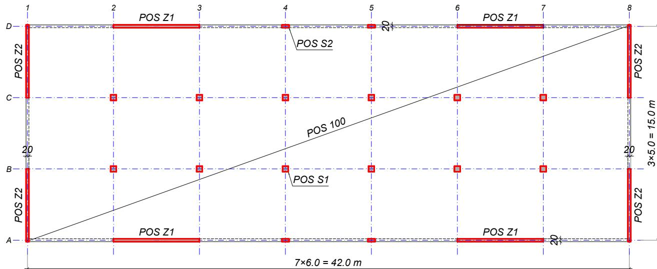
Osnova tipskog sprata poslovne zgrade sa vertikalnim konstruktivnim elementima prikazana je na skici. Spratna visina je 3.3 m, a ukupna visina konstrukcije od kote uklještenja iznosi  $H = 8 \times 3.3 = 26.4$  m (prizemlje i 7 spratova). Nije potrebno razmatrati položaj stepeništa. Međuspratna tavanica je ploča debljine 20 cm direktno oslonjena na stubove i zidove (postoje samo fasadne grede). Krovnu ploču tretirati kao tipsku tavanicu.
