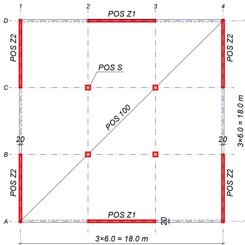
Osnova tipskog sprata poslovne zgrade sa vertikalnim konstruktivnim elementima prikazana je na skici. Spratna visina je 4.0 m, a ukupna visina konstrukcije od kote uklještenja iznosi  $H = 6 \times 4.0 = 24$  m (prizemlje i 5 spratova). Nije potrebno razmatrati položaj stepeništa. Međuspratna tavanica je ploča debljine **22 cm** direktno oslonjena na stubove i zidove (postoje samo fasadne grede). Krovnu ploču tretirati kao tipsku tavanicu.
