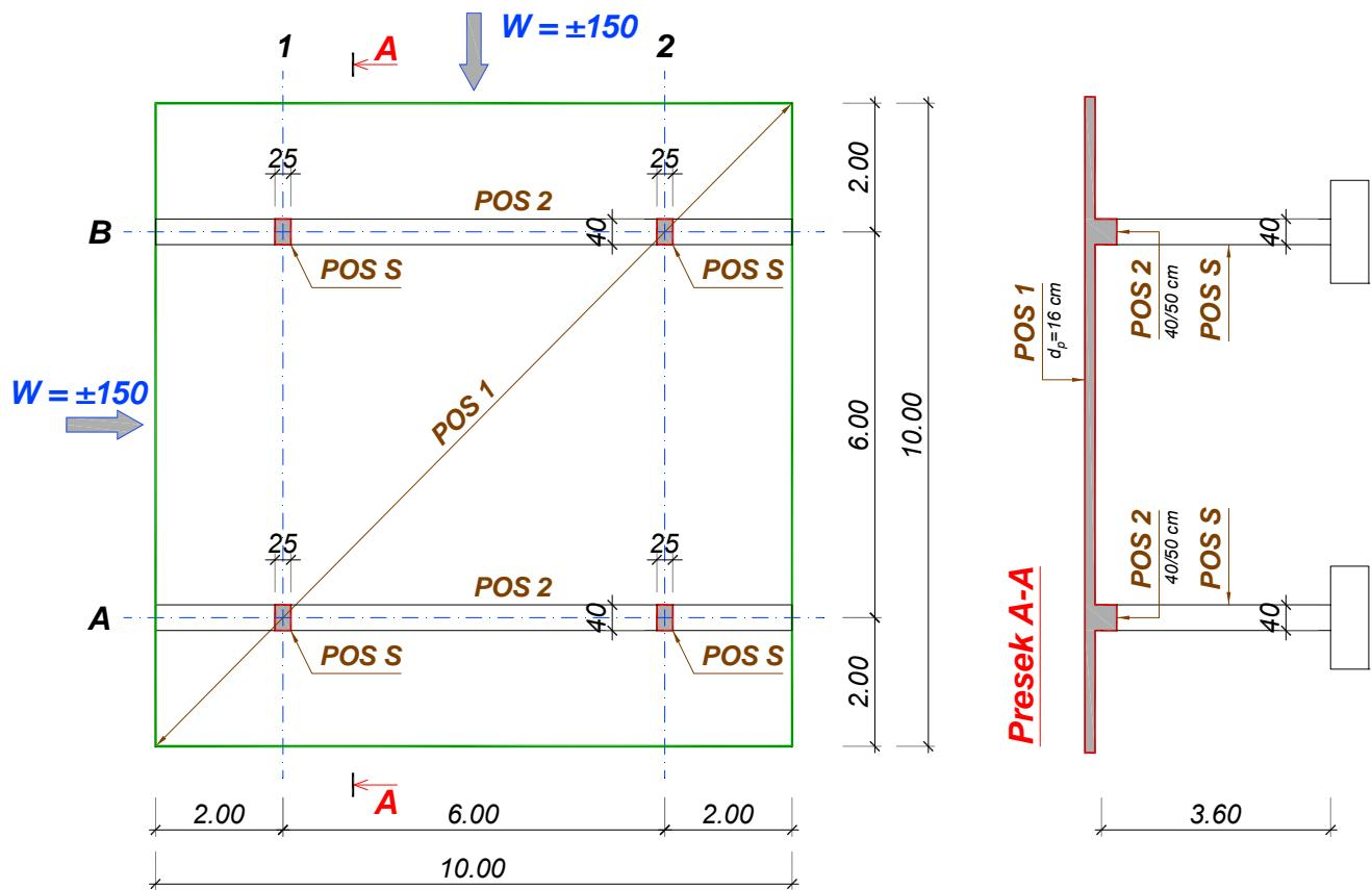
Konstrukcija prikazana na skici, pored sopstvene težine elemenata, opterećena je jednako raspodeljenim povremenim opterećenjem  $q = 10 \text{ kN/m}^2$  koje deluje po čitavoj površini ploče.
