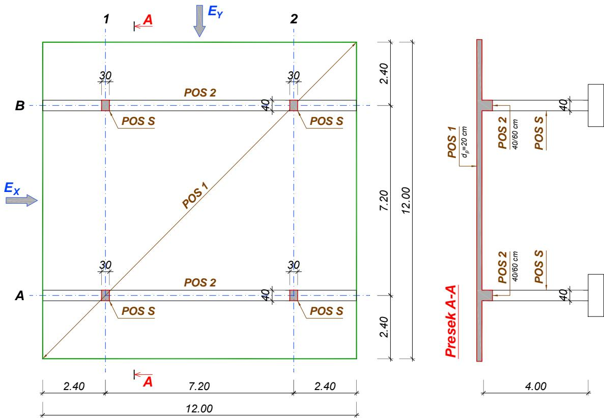
Konstrukcija prikazana na skici, pored sopstvene težine elemenata, opterećena je jednako raspodeljenim povremenim opterećenjem  $q = 10 \text{ kN/m}^2$  koje deluje po čitavoj površini ploče.
