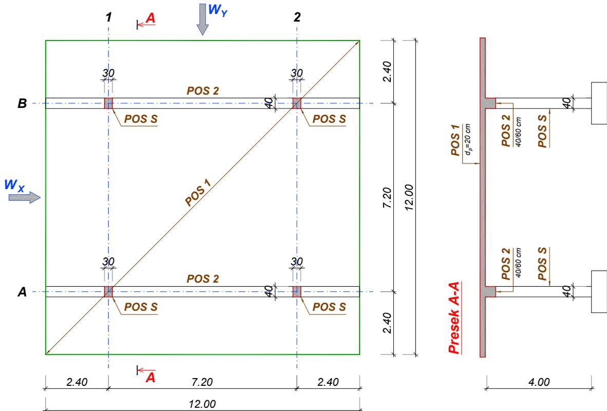
Konstrukcija prikazana na skici, pored sopstvene težine elemenata, opterećena je jednako raspodeljenim povremenim opterećenjem  $q = 10 \text{ kN/m}^2$ .
