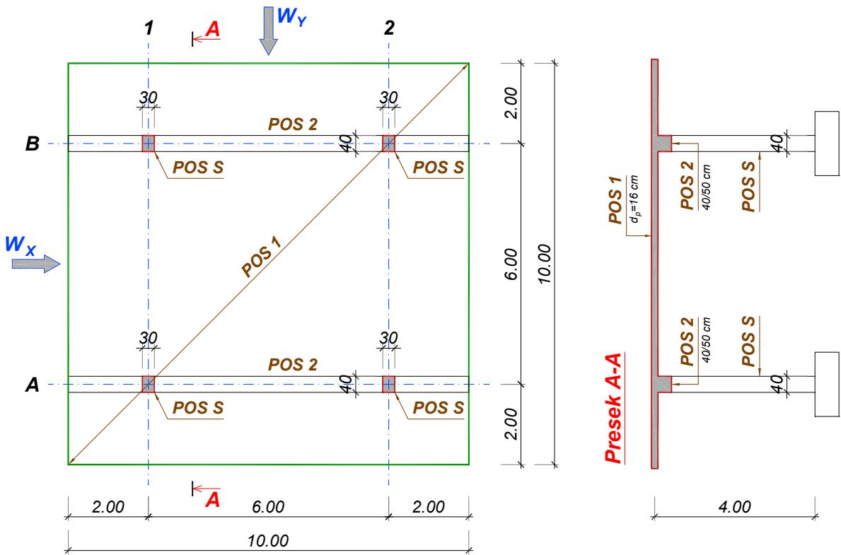
Konstrukcija prikazana na skici, pored sopstvene težine elemenata, opterećena je jednako raspodeljenim povremenim opterećenjem  $q = 15 \text{ kN/m}^2$ .
