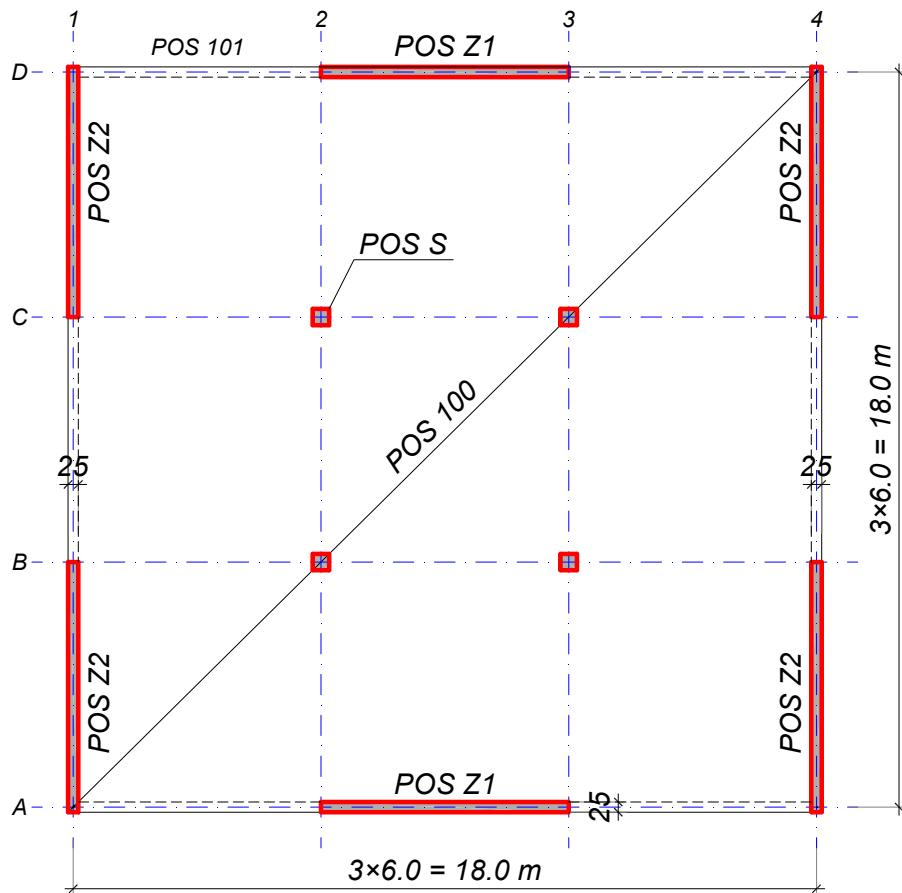
Osnova tipskog sprata poslovne zgrade sa vertikalnim konstruktivnim elementima prikazana je na skici. Spratna visina je 3.5 m, a ukupna visina konstrukcije od kote uklještenja iznosi  $H = 6 \times 3.5 = 21$  m. Međuspratna tavanica je ploča debljine **22 cm** direktno oslonjena na kvadratne stubove POS S i AB zidove dimenzija 25/600 cm (postoje samo fasadne gredе). Krovnu ploču tretirati kao tipsku tavanicu.
