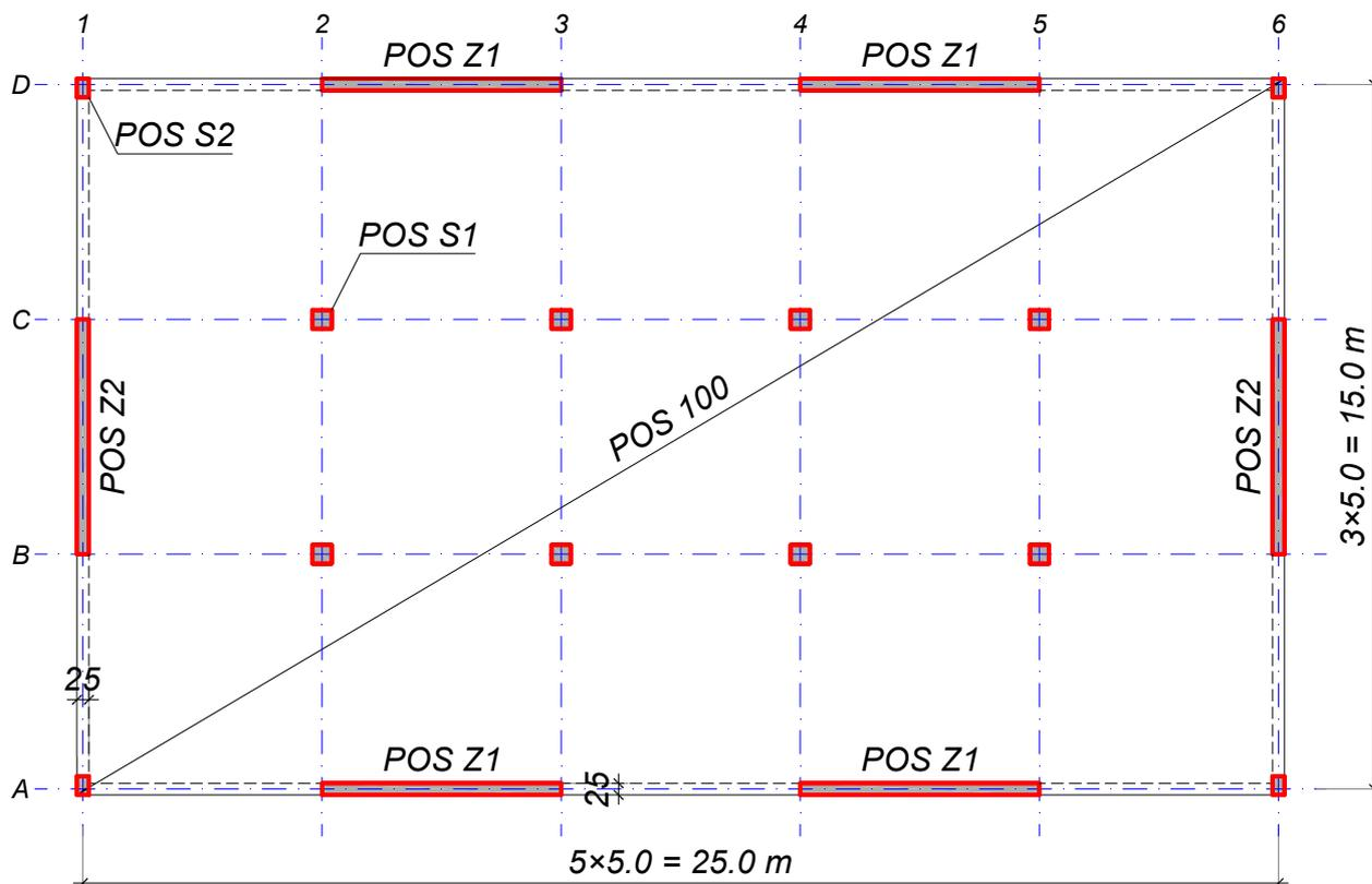
Osnova tipskog sprata skladišta sa vertikalnim konstruktivnim elementima prikazana je na skici. Spratna visina je 3.6 m, a ukupna visina konstrukcije od kote uklještenja iznosi  $H = 5 \times 3.6 = 18$  m. Tavanica je ploča debljine 20 cm direktno oslonjena na stubove POS S1, POS S2 i AB zidove dimenzija 25/500 cm (postoje samo fasadne grede). Krovnu ploču tretirati kao tipsku tavanicu.
