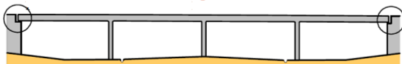
Семинтегрални мост - дилатације и лежишта само на опорцима
