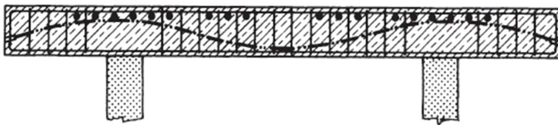
попечно преднапрезање код средњих ослонаца (скривена греда)
