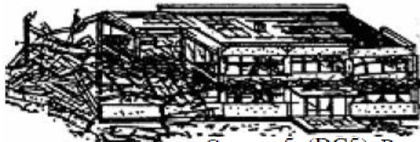
Степен 5. (DG5) Рушење (врло јако оштећење носеће конструкције);
