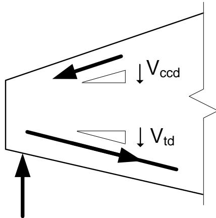
*Nosivost na smicanje elementa sa armaturom za smicanje:*
