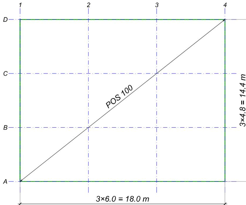
Uraditi idejno rešenje armiranobetonske konstrukcije poslovne zgrade. Osnova tipskog sprata sa rasterom data je na skici. Spratna visina je 4 m, a ukupna visina konstrukcije od kote uklještenja iznosi  $H = 6 \times 4.0 = 24$  m (prizemlje i 5 spratova). Pri usvajanju idejnog rešenja ne treba razmatrati položaj stepeništa. Krovnu ploču tretirati kao tipsku tavanicu. Težina fasadne obloge je zanemarljiva.
