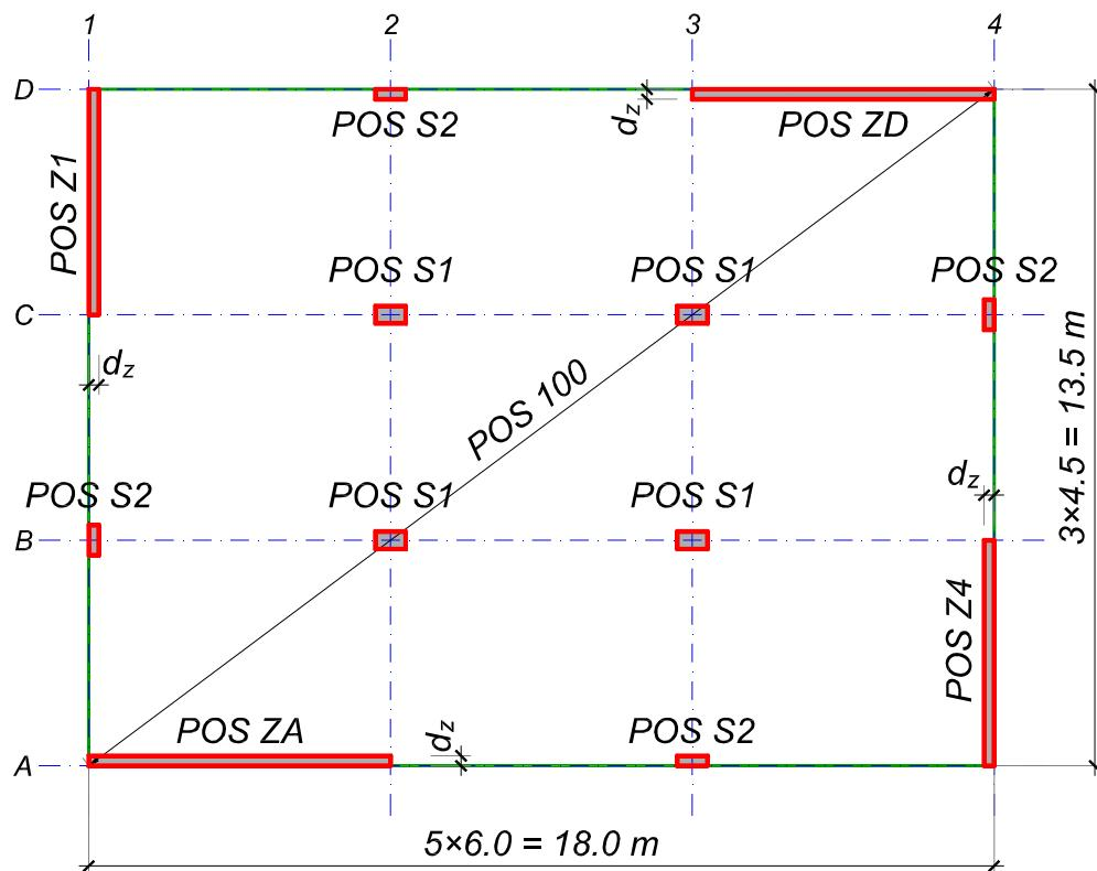
Uraditi idejno rešenje armiranobetonske konstrukcije poslovne zgrade. Osnova tipskog sprata sa rasterom data je na skici. Spratna visina je 3 m, a ukupna visina konstrukcije od kote uklještenja iznosi  $H = 10 \times 3.0 = 30$  m (prizemlje i 9 spratova). Pri usvajaju idejnog rešenja ne treba razmatrati položaj stepeništa. Krovnu ploču tretirati kao tipsku tavanicu. Težina fasadne obloge je zanemarljiva.
