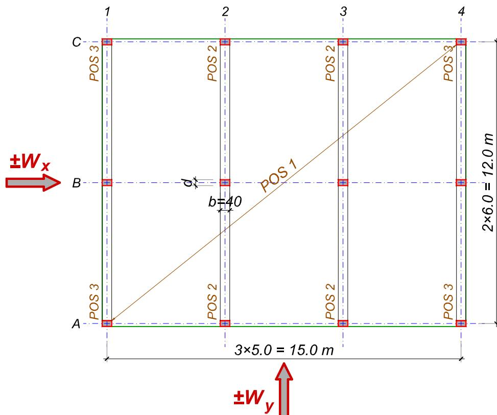
Na skici je prikazana osnova jednospratne armiranobetonske konstrukcije. Ukupna visina konstrukcije od kote uklještenja iznosi  $H = 4.2 \text{ m}$ .
