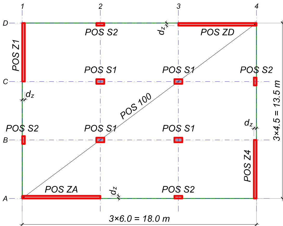
Uraditi idejno rešenje armiranobetonske konstrukcije poslovne zgrade. Osnova tipskog sprata sa rasterom data je na skici. Spratna visina je 3.2 m, a ukupna visina konstrukcije od kote uklještenja iznosi  $H = 9 \times 3.2 = 28.8\text{ m}$  (prizemlje i 8 spratova). Pri usvajaju idejnog rešenja ne treba razmatrati položaj stepeništa. Krovnu ploču tretirati kao tipsku tavanicu. Težina fasadne obloge je zanemarljiva.
