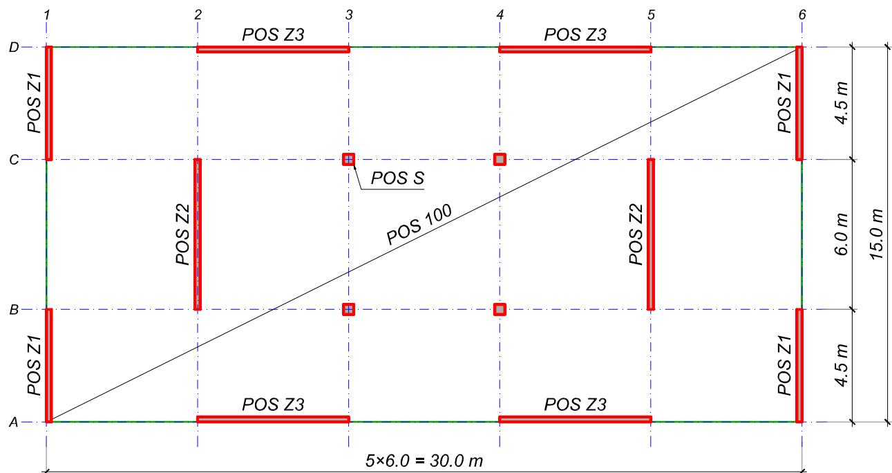
Osnova tipskog sprata poslovne zgrade sa vertikalnim konstruktivnim elementima prikazana je na skici. Spratna visina je  $3.5 \text{ m}$ , a ukupna visina konstrukcije od kote uklještenja iznosi  $H = 8 \times 3.5 = 28 \text{ m}$  (prizemlje i 7 spratova). Nije potrebno razmatrati položaj stepeništa. Međuspratna tavanica je ploča direktno oslonjena na vertikalne elemente (greda nema ni u fasadi). Krovnu ploču tretirati kao tipsku tavanicu.
