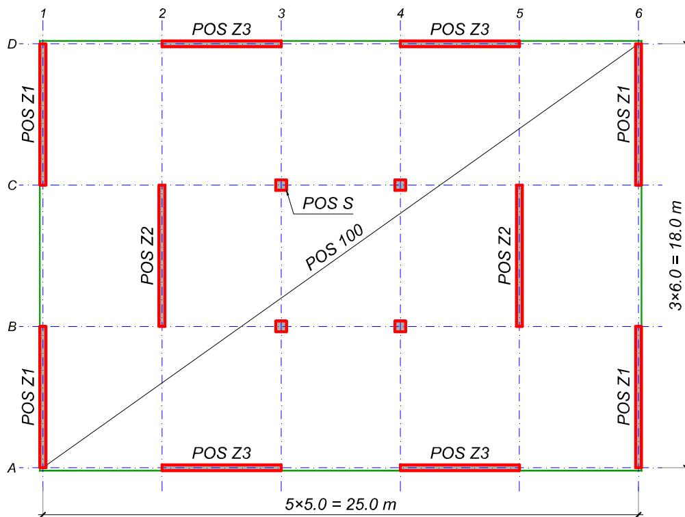
Osnova tipskog sprata poslovne zgrade sa vertikalnim konstruktivnim elementima prikazana je na skici. Spratna visina je 3.0 m, a ukupna visina konstrukcije od kote uklještenja iznosi  $H = 10 \times 3.0 = 30$  m (prizemlje i 9 spratova). Nije potrebno razmatrati položaj stepeništa. Međuspratna tavanica je ploča direktno oslonjena na vertikalne elemente (greda nema ni u fasadi). Krovnu ploču tretirati kao tipsku tavanicu.
