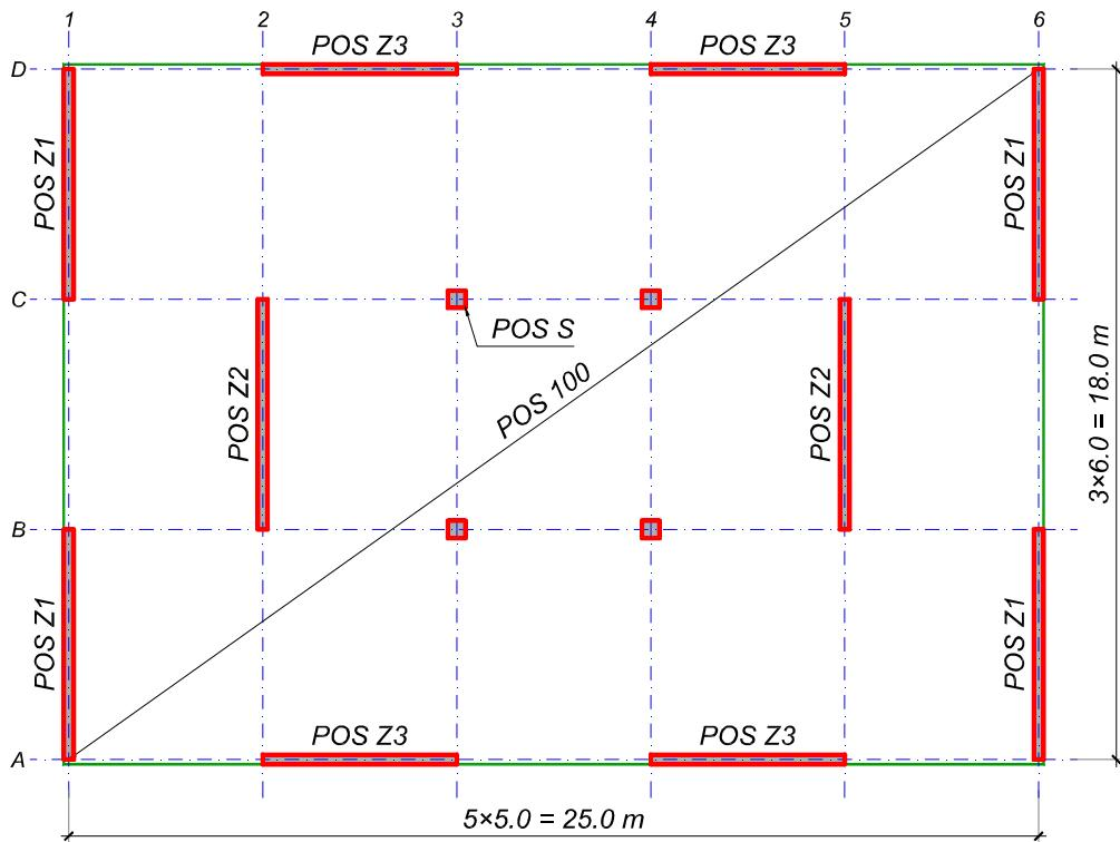
Osnova tipskog sprata poslovne zgrade sa vertikalnim konstruktivnim elementima prikazana je na skici. Spratna visina je 4.0 m, a ukupna visina konstrukcije od kote uklještenja iznosi  $H = 6 \times 4.0 = 24$  m (prizemlje i 5 spratova). Nije potrebno razmatrati položaj stepeništa. Međuspratna tavanica je ploča direktno oslonjena na vertikalne elemente (greda nema ni u fasadi). Krovnu ploču tretirati kao tipsku tavanicu.
