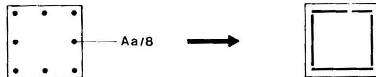
Slika 7. Aproksimacija poprečnog preseka sa 8 profila armature.
