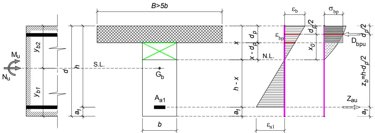
Zbog velike površine (nosivosti) pritisnutog dela betonskog preseka, kod ovakvog oblika poprečnog preseka prisustvo armature u pritisnutoj zoni je nepotrebno (barem u računskom smislu), pa je stoga  $D_{au} \equiv 0$ . S druge strane, zanemarenjem nosivosti rebara i uprosečavanjem napona pritiska u ploči, može se napisati:
