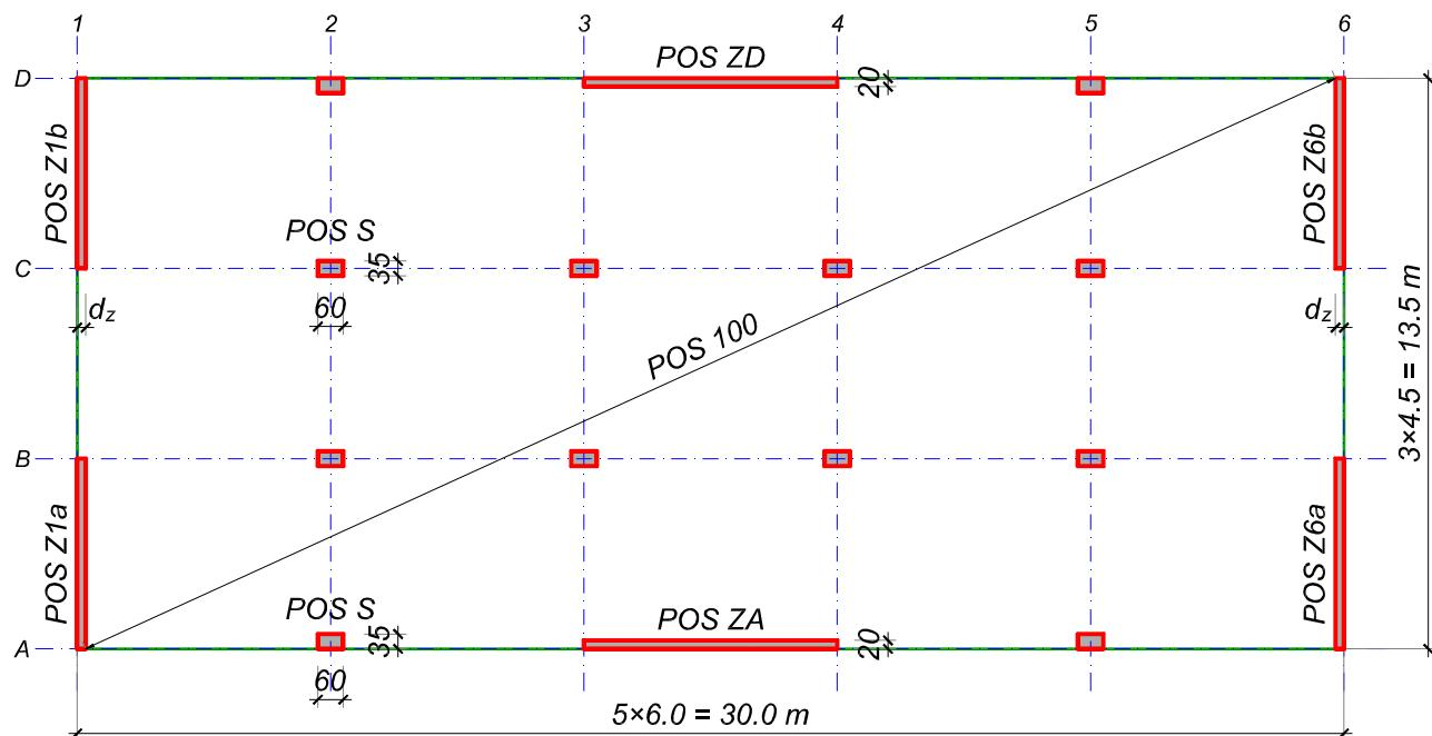
Osnova tipskog sprata poslovne zgrade sa vertikalnim konstruktivnim elementima prikazana je na skici. Spratna visina je 4 m, a ukupna visina konstrukcije od kote uklještenja iznosi  $H = 7 \times 4.0 = 28$  m (prizemlje i 6 spratova). Nije potrebno razmatrati položaj stepeništa. Međuspratna tavanica je ploča direktno oslonjena na vertikalne elemente (grede nisu dopuštene ni u fasadi). Krovnu ploču tretirati kao tipsku tavanicu.
