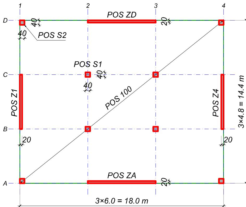
Osnova tipskog sprata poslovne zgrade sa vertikalnim konstruktivnim elementima prikazana je na skici. Spratna visina je 4 m, a ukupna visina konstrukcije od kote uklještenja iznosi  $H = 6 \times 4.0 = 24 \text{ m}$  (prizemlje i 5 spratova). Nije potrebno razmatrati položaj stepeništa. Međuspratna tavanica je ploča direktno oslonjena na vertikalne elemente (grede nisu dopuštene ni u fasadi). Krovnu ploču tretirati kao tipsku tavanicu.
