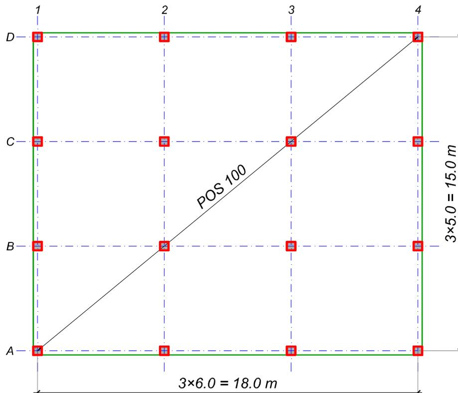
Monolitna armiranobetonska ploča, debljine  $d_p = 20$  cm, oslonjena je na 16 stubova kvadratnog poprečnog preseka dimenzija  $35 \times 35$  cm. Ukupna visina konstrukcije od kote ukleštenja iznosi  $H = 3.6$  m. Težine obloga i fasada se mogu zanemariti.
