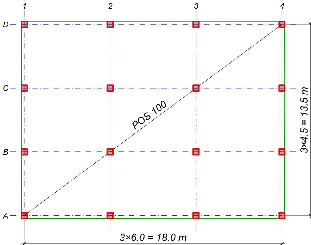
Uraditi idejno rešenje jednospratne armiranobetonske konstrukcije. Osnova sa rasterom data je na skici. Ukupna visina konstrukcije od kote uklještenja iznosi  $H = 4$  m.
