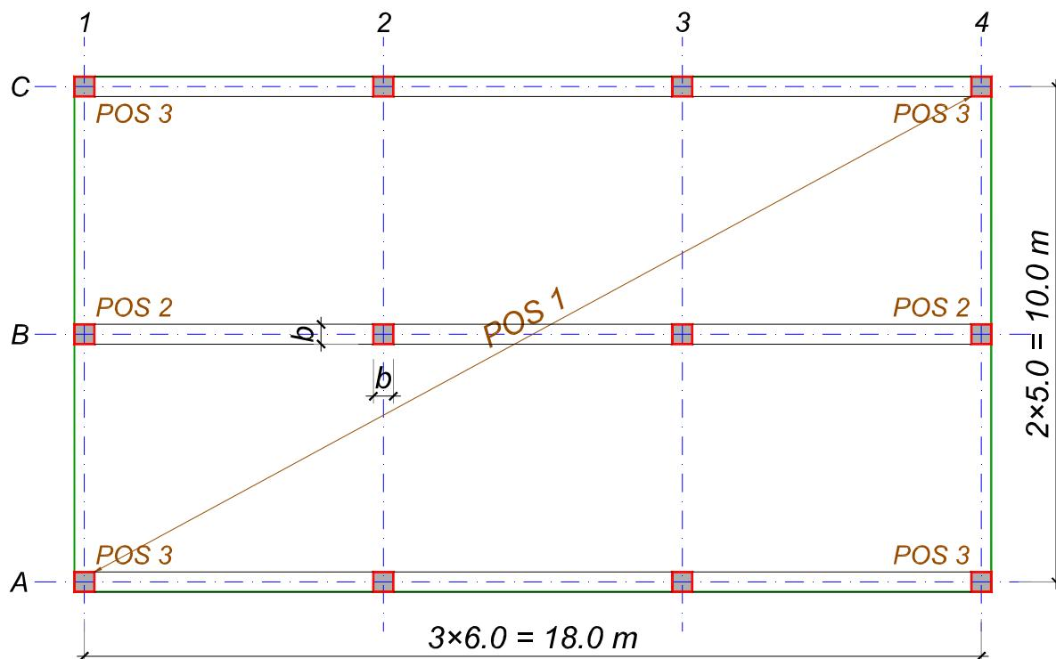
Na skici je prikazana osnova jednospratne armiranobetonske konstrukcije. Ukupna visina konstrukcije od kote uklještenja iznosi  $H = 4 \text{ m}$ .
