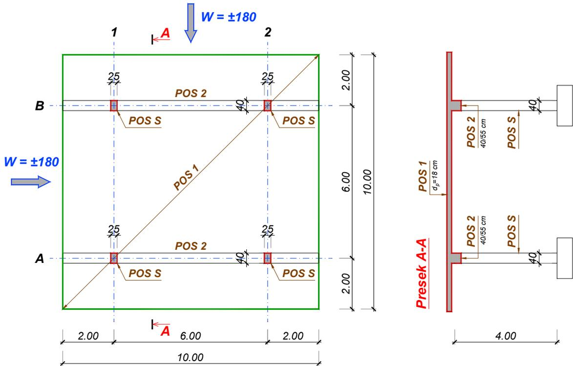
1 Konstrukcija prikazana na skici, pored sopstvene težine elemenata, opterećena je jednako raspodeljenim povremenim opterećenjem  $p = 9 \text{ kN/m}^2$  koje se može naći u **PROIZVOLJNOM** položaju na ploči POS 1.
