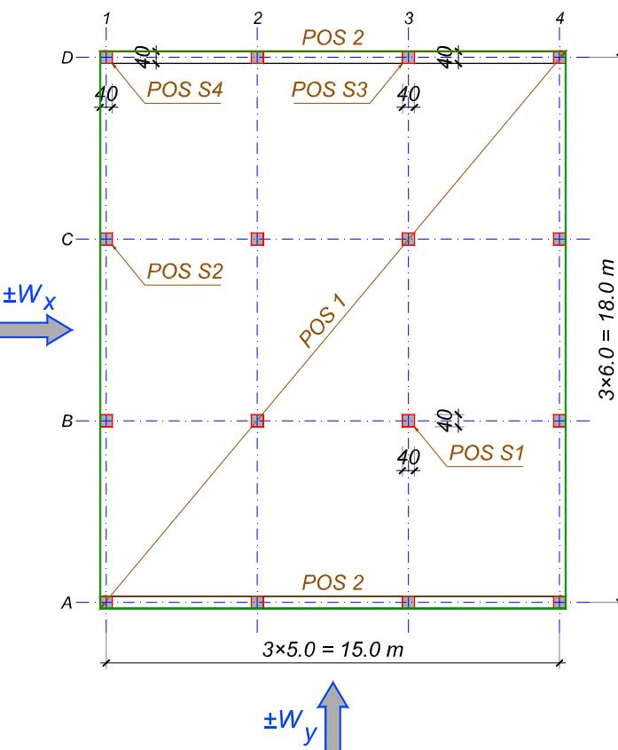
Ploča **POS 1** ( $d_p = 20 \text{ cm}$ ), opterećena je, pored sopstvene težine, dodatnim stalnim opterećenjem  $Dg = 2.5 \text{ kN/m}^2$  i povremenim opterećenjem  $p = 7.5 \text{ kN/m}^2$ . Ploča je oslonjena na stubove kvadratnog poprečnog preseka (40/40 cm), visine  $H = 4.0 \text{ m}$ . U osama A i D izvedene su AB greda **POS 2**, dimenzija 40/50 cm. Dejstvo veta na objekat je predstavljeno ukupnim silama  $\pm W_x = 360 \text{ kN}$  odnosno  $\pm W_y = 300 \text{ kN}$ . Potrebno je:
