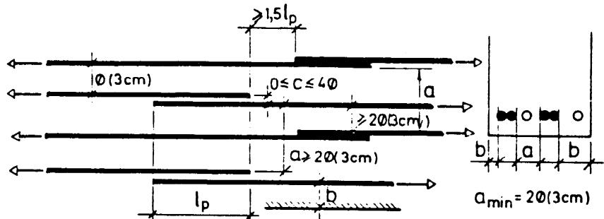
Najveći dozvoljeni procent nastavljanja zategnute armature preklapanjem u jednom preseku može iznositi:
