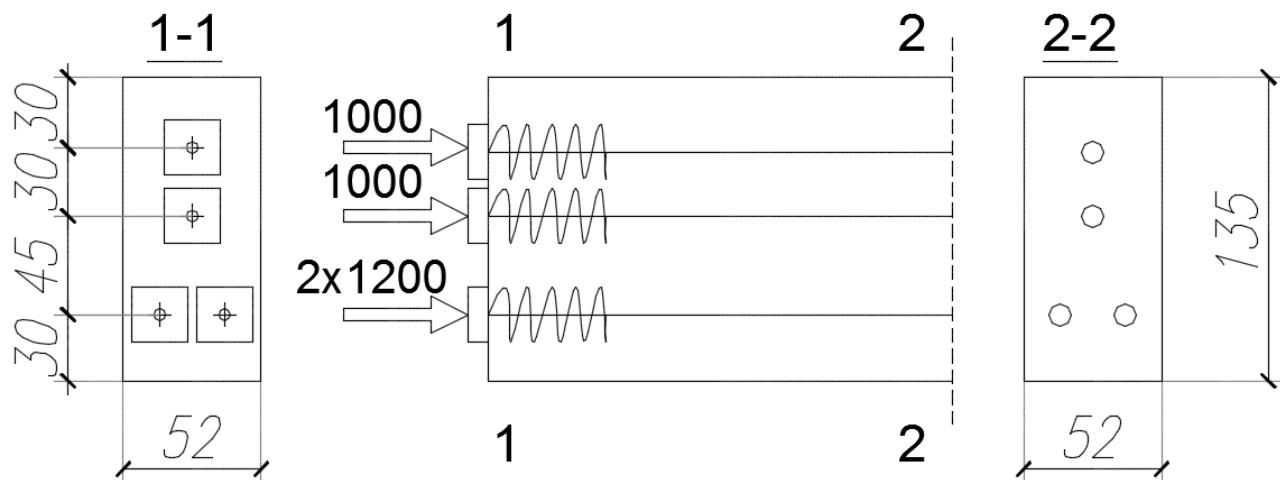
5. Montažna greda sa prikazanim konstantnim presekom ima raspon od 22.0 m. Nakon montaže nanosi se dodatni teret  $\Delta g = 8 \text{ kN/m}^2$ . Povremeni teret je  $p = 11 \text{ kN/m}$ .
