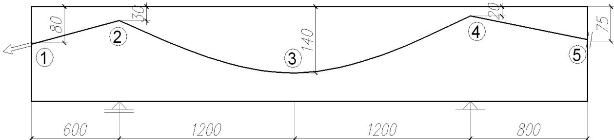
3. Za prikazani nosač i trasu rezultantnog kabla sračunati ekvivalentno opterećenje i nacrtati dijagrame presečnih sila  $M$ ,  $V (=T)$ ,  $N$  samo od uticaja PN. Sile u kablovima su  $P_1 = 5000$  kN i  $P_2 = 5500$  kN. Prikazati veličine reakcija oslonaca i nacrtati i dijagram momenata ( $M$ ) samo usled reakcija. Poprečni presek je pravougaoni.
