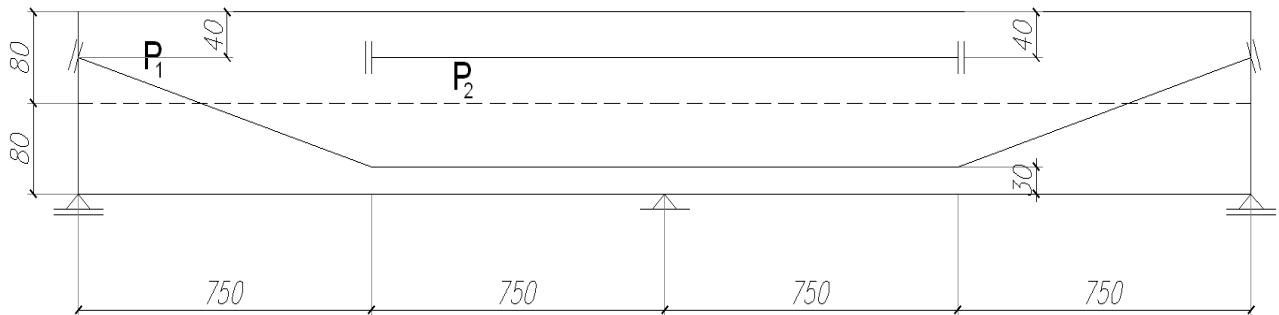
4. Za prikazani presek od betona MB40 sračunati graničnu nosivost na savijanje (moment 'loma'). Dilatacija čelika za PN pri dekomprimaciji iznosi 5,4 %. Koristiti dijagram parabola-prava za beton prema PBAB '87. Obavezno uračunati prikazanu zategnutu armaturu (RA 400/500). Pritisнутa armatura ima zanemarljivu površinu.
