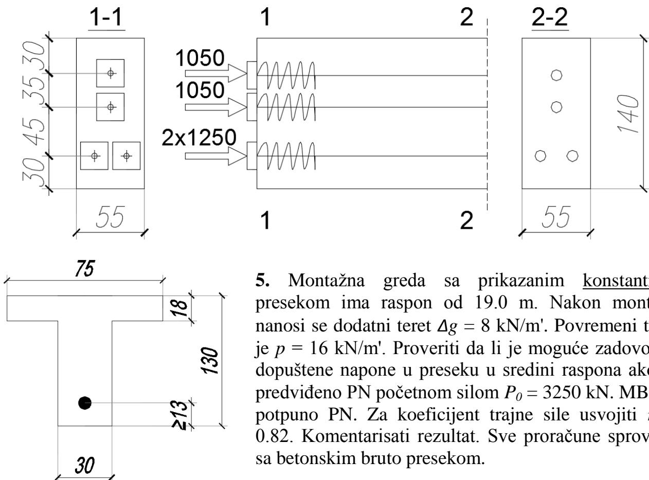
5. Montažna greda sa prikazanim konstantnim presekom ima raspon od 19.0 m. Nakon montaže nanosi se dodatni teret  $\Delta g = 8$  kN/m'. Povremeni teret je  $p = 16$  kN/m'. Proveriti da li je moguće zadovoljiti dopuštene napone u preseku u sredini raspona ako je predviđeno PN početnom silom  $P_0 = 3250$  kN. MB 50, potpuno PN. Za koeficijent trajne sile usvojiti  $\eta = 0.82$ . Komentarisi rezultat. Sve proračune sprovesti sa betonskim bruto presekom.
