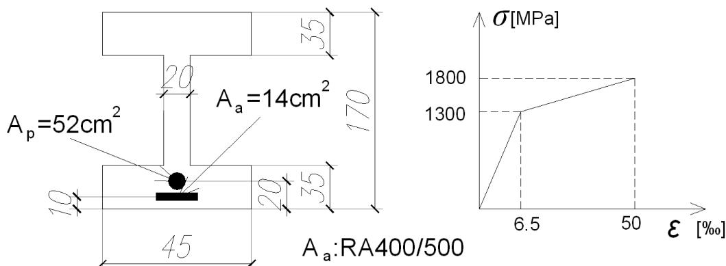
5. Sračunati ugib u sredini raspona u  $t \rightarrow \infty$  prikazanog prethodno napregnutog nosača pri delovanju naznačenog opterećenja. Sila u kablu je  $P_0 = N_{k0} = 4400$  kN,  $\eta = \omega = 0.82$ ,  $\varphi(t, t_0) = 3.0$ ,  $\varphi(t, t_1) = 2.2$ , MB40,  $g$  je sopstvena težina – prema preseku,  $\Delta g = 18.0$  kN/m' ( $\Delta g$  počinje da deluje od  $t_1$ ),  $p = 22.0$  kN/m' (povremeno opterećenje). Poprečni presek je pravougaoni  $40 \times 170$  cm.
