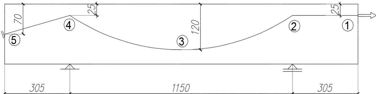
3. Za prikazani nosač i trasu rezultantnog kabla sračunati ekvivalentno opterećenje i nacrtati dijagrame presečnih sila  $M$ ,  $V (=T)$ ,  $N$  samo od uticaja PN. Sile u kablovima su  $P_1 = 6000$  kN i  $P_2 = 4500$  kN. Prikazati veličine reakcija oslonaca i nacrtati i dijagram momenata ( $M$ ) samo usled reakcija. Poprečni presek je pravougaoni.
