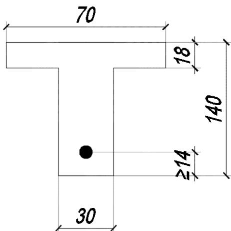
4. Montažna greda sa prikazanim konstantnim presekom ima raspon od 18.0 m. Nakon montaže nanosi se dodatni teret  $\Delta g = 8 \text{ kN/m}^2$ . Povremeni teret je  $p = 16 \text{ kN/m}^2$ . Proveriti da li je moguće zadovoljiti dopuštene napone u preseku u sredini raspona ako je predviđeno PN početnom silom  $P_0 = 2250 \text{ kN}$ . MB 50, ograničeno PN. Za koeficijent trajne sile usvojiti  $\eta = 0.84$ . Komentarisi rezultat. Sve proračune sprovesti sa betonskim bruto presekom.
