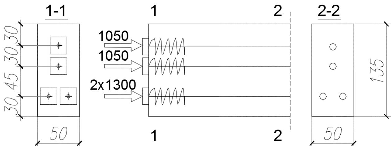
5. Montažna greda sa prikazanim konstantnim presekom ima raspon od 20.0 m. Nakon montaže nanosi se dodatni teret  $\Delta g = 9 \text{ kN/m}^2$ . Povremeni teret je  $p = 12 \text{ kN/m}$ .
