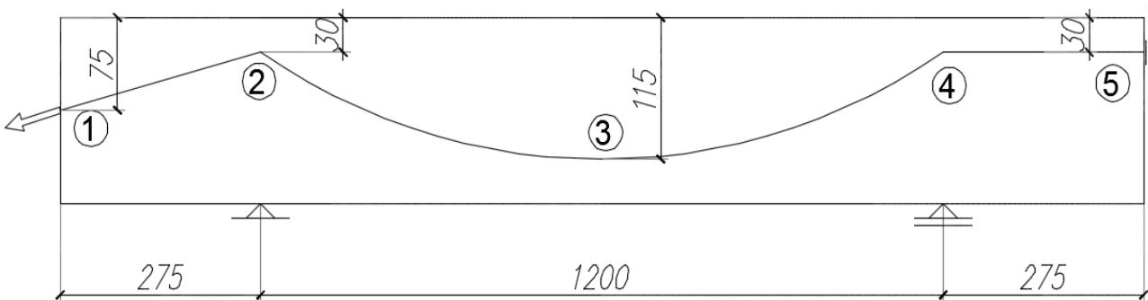
3. Za prikazani nosač i trasu rezultantnog kabla sračunati ekvivalentno opterećenje i nacrtati dijagrame presečnih sila  $M$ ,  $V (=T)$ ,  $N$  samo od uticaja PN. Sile u kablovima su  $P_1 = 6000$  kN i  $P_2 = 4500$  kN. Prikazati veličine reakcija oslonaca i nacrtati i dijagram momenata ( $M$ ) samo usled reakcija. Poprečni presek je pravougaoni.
