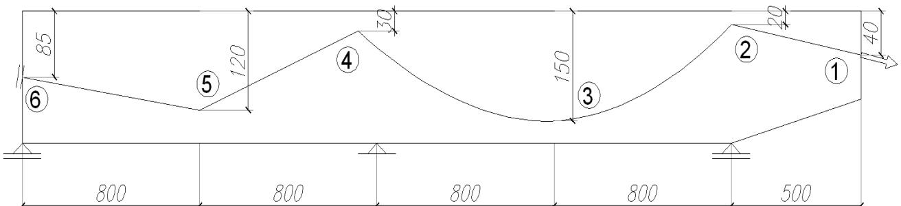
3. Za prikazani nosač i trasu rezultantnog kabla sračunati ekvivalentno opterećenje i nacrtati dijagrame presečnih sila  $M$ ,  $V (=T)$ ,  $N$  samo od uticaja PN. Sile u kablovima su  $P_1 = 5500$  kN i  $P_2 = 5000$  kN. Prikazati veličine reakcija oslonaca i nacrtati i dijagram momenata ( $M$ ) samo usled reakcija. Poprečni presek je pravougaoni.
