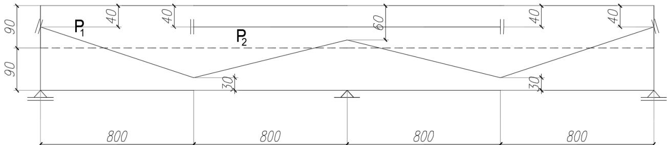
4. Za prikazani ankerni blok i raspored kotvi sračunati i usvojiti armaturu (GA240/360) za osiguranje zone uvođenja sile PN. Silu cepanja proceniti modelom slobodnog tela. Poprečni presek grede i ankernog bloka su isti (pravougaoni). Sila po jednoj kotvi je  $P_1^{(I)} = 1200$  kN i  $P_2^{(I)} = 1000$  kN. Nacrtati u razmeri plan usvojene armature.
