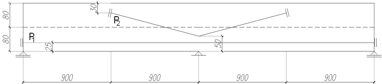
4. Za prikazani ankerni blok i raspored kotvi sračunati i usvojiti armaturu (GA240/360) za osiguranje zone uvođenja sile PN. Silu cepanja proceniti modelom slobodnog tela. Poprečni presek grede i ankernog bloka su isti (pravougaoni). Sila po jednoj kotvi je  $P_1^{(1)} = 1250$  kN i  $P_2^{(1)} = 1050$  kN. Nacrtati u razmeri plan usvojene armature.
