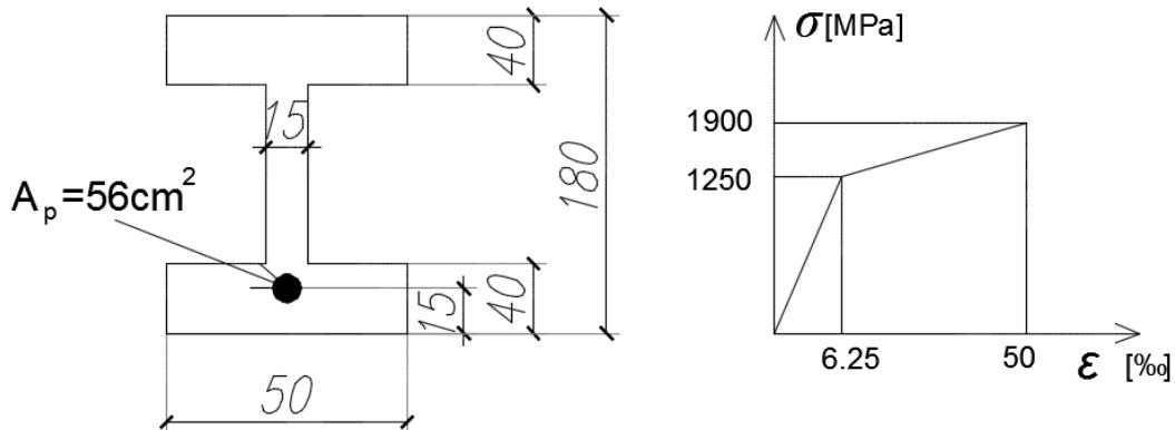
5. Sračunati ugib na kraju konzole u  $t \rightarrow \infty$  prikazanog prethodno napregnutog nosača pri delovanju naznačenog opterećenja. Sila u kablu je  $P_0 = N_{k0} = 4800$  kN,  $\eta = \omega = 0.82$ ,  $\varphi(t, t_0) = 2.6$ ,  $\varphi(t, t_1) = 2.0$ , MB50,  $g$  je sopstvena težina – prema preseku,  $\Delta g = 16.0$  kN/m' ( $\Delta g$  počinje da deluje od  $t_1$ ),  $M_p = 1100$  kNm (povremeno opterećenje). Poprečni presek je pravougaoni  $40 \times 180$  cm.
