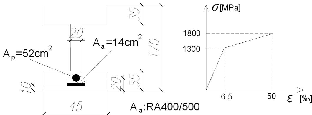
5. Sračunati ugib u sredini raspona u  $t \rightarrow \infty$  prikazanog prethodno napregnutog nosača pri delovanju naznačenog opterećenja. Sila u kablu je  $P_0 = N_{k0} = 4000$  kN,  $\eta = \omega = 0,8$ ,  $\varphi(t, t_0) = 2,6$ ,  $\varphi(t, t_1) = 2,1$  MB45,  $g$  je sopstvena težina – prema preseku,  $\Delta g = 9,0$  kN/m' ( $\Delta g$  počinje da deluje od  $t_1$ ),  $P = 550$  kN (povremeno opterećenje). Poprečni presek je pravougaoni  $30 \times 150$  cm.
