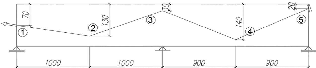
3. Za prikazani presek od betona MB55 sračunati graničnu nosivost na savijanje (moment 'loma'). Dilatacija čelika za PN pri dekomprimaciji iznosi 5,2 %. Koristiti dijagram parabola-prava za beton prema PBAB '87. Obavezno uračunati prikazanu zategnutu armaturu (RA 400/500). Pritisnuta armatura ima zanemarljivu površinu.
