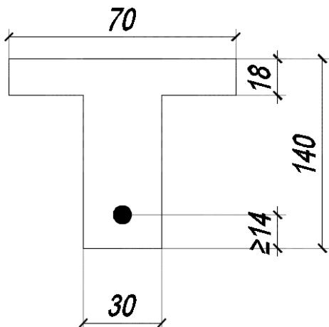
4. Montažna greda sa prikazanim konstantnim presekom ima raspon od 20.0 m. Nakon montaže nanosi se dodatni teret  $\Delta g = 8 \text{ kN/m}^2$ . Povremeni teret je  $p = 16 \text{ kN/m}$ . Proveriti da li je moguće zadovoljiti dopuštene napone u preseku u sredini raspona ako je predviđeno PN početnom silom  $P_0 = 2200$  kN. MB 50, ograničeno PN. Za koeficijent trajne sile usvojiti  $\eta = 0.84$ . Komentarisati rezultat. Sve proračune sprovesti sa betonskim bruto presekom.
