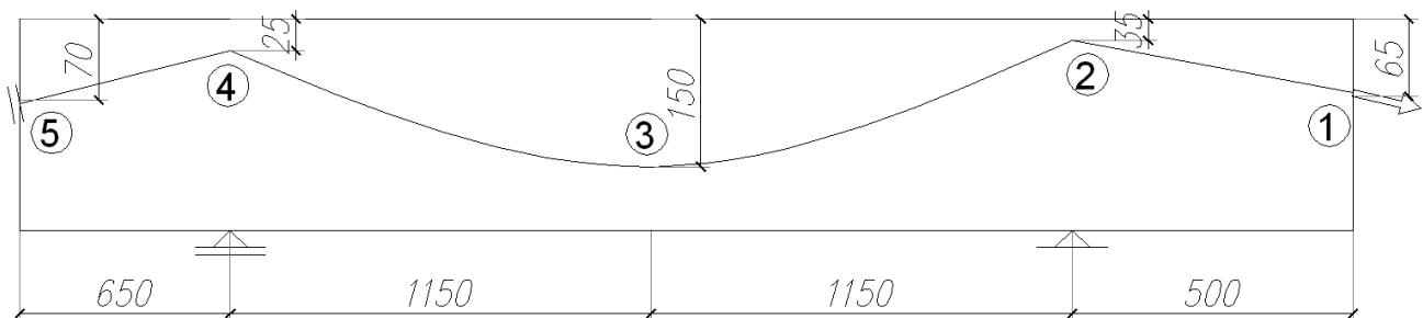
4. Za prikazani presek od betona MB50 sračunati graničnu nosivost na savijanje (moment 'loma'). Dilatacija čelika za PN pri dekomprimisiji iznosi 4,8 %. Koristiti dijagram parabola-prava za beton prema PBAB '87. Obavezno uračunati prikazanu zategnutu armaturu (RA 400/500). Pritisnuta armatura ima zanemarljivu površinu.
