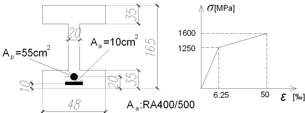
5. Sračunati ugib u sredini raspona u  $t \rightarrow \infty$  prikazanog prethodno napregnutog nosača pri delovanju naznačenog opterećenja. Sila u kablu je  $P_0 = N_{k0} = 5000$  kN,  $\eta = \omega = 0,8$ ,  $\varphi(t, t_0) = 2,6$ ,  $\varphi(t, t_1) = 2,1$  MB45,  $g$  je sopstvena težina – prema preseku,  $\Delta g = 19,5$  kN/m' ( $\Delta g$  počinje da deluje od  $t_1$ ),  $P = 500$  kN (povremeno opterećenje). Poprečni presek je pravougaoni  $40 \times 170$  cm.
