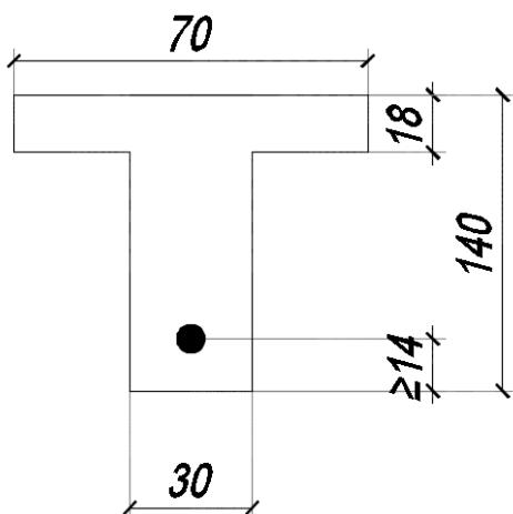
4. Montažna greda sa prikazanim konstantnim presekom ima raspon od 20.0 m. Nakon montaže nanosi se dodatni teret  $\Delta g = 8 \text{ kN/m}^2$ . Povremeni teret je  $p = 16 \text{ kN/m}$ . Proveriti da li je moguće zadovoljiti dopuštene napone u preseku u sredini raspona ako je predviđeno PN početnom silom  $P_0 = 2300$  kN. MB 50, ograničeno PN. Za koeficijent trajne sile usvojiti  $\eta = 0.82$ . Komentarisati rezultat. Sve proračune sprovesti sa betonskim bruto presekom.
