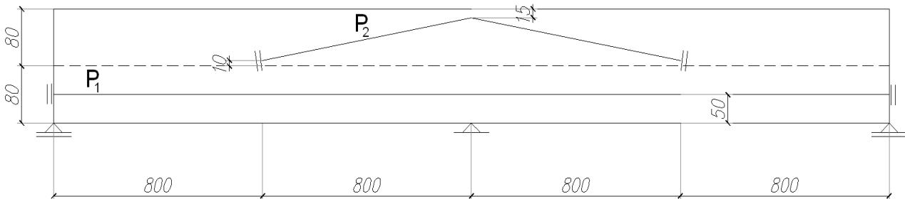
4. Za prikazani presek od betona MB40 sračunati graničnu nosivost na savijanje (moment 'loma'). Dilatacija čelika za PN pri dekomprimaciji iznosi 5,4 %. Koristiti dijagram parabola-prava za beton prema PBAB '87. Obavezno uračunati prikazanu zategnutu armaturu (RA 400/500). Pritisnuta armatura ima zanemarljivu površinu.
