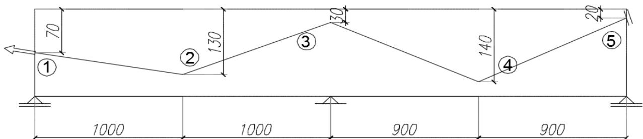
5. Za prikazani presek od betona MB55 sračunati graničnu nosivost na savijanje (moment 'loma'). Dilatacija čelika za PN pri dekompresiji iznosi 5,2 %. Koristiti dijagram parabola-prava za beton prema PBAB '87. Obavezno uračunati prikazanu zategnutu armaturu (RA 400/500). Pritisnuta armatura ima zanemarljivu površinu.
