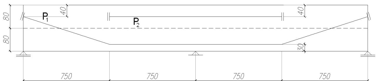
5. Sračunati ugib u sredini raspona u  $t \rightarrow \infty$  prikazanog prethodno napregnutog nosača pri delovanju naznačenog opterećenja. Sila u kablu je  $P_0 = N_{k0} = 5500$  kN,  $\eta = \omega = 0.82$ ,  $\varphi(t, t_0) = 2.8$ ,  $\varphi(t, t_1) = 2.3$  MB50, g je sopstvena težina – prema preseku,  $\Delta g = 20.0$  kN/m' ( $\Delta g$  počinje da deluje od  $t_1$ ),  $P = 500$  kN (povremeno opterećenje). Poprečni presek je pravougaoni  $30 \times 170$  cm.
