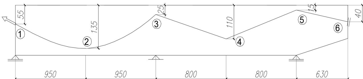
3. Za prikazani nosač i trasu rezultantnog kabla sračunati ekvivalentno opterećenje i nacrtati dijagrame presečnih sila  $M$ ,  $V (=T)$ ,  $N$  samo od uticaja PN. Sile u kablovima su  $P_1 = 5500$  kN i  $P_2 = 2500$  kN. Prikazati veličine reakcija oslonaca i nacrtati i dijagram momenata ( $M$ ) samo usled reakcija. Poprečni presek je pravougaoni.
