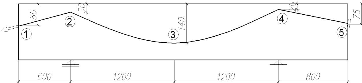
3. Za prikazani nosač i trasu rezultantnog kabla sračunati ekvivalentno opterećenje i nacrtati dijagrame presečnih sila  $M$ ,  $V (=T)$ ,  $N$  samo od uticaja PN. Sile u kablovima su  $P_1 = 5000$  kN i  $P_2 = 5500$  kN. Prikazati veličine reakcija oslonaca i nacrtati i dijagram momenata ( $M$ ) samo usled reakcija. Poprečni presek je pravougaoni.
