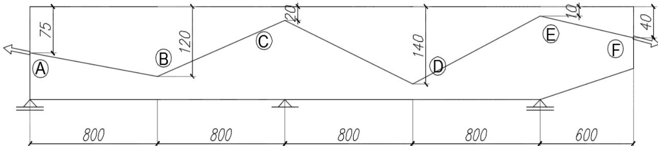
3. Za prikazani nosač i trasu rezultantnog kabla sračunati ekvivalentno opterećenje i nacrtati dijagrame presečnih sila  $M$ ,  $V (=T)$ ,  $N$  samo od uticaja PN. Sile u kablovima su  $P_1 = 5000$  kN i  $P_2 = 4000$  kN. Prikazati veličine reakcija oslonaca i nacrtati i dijagram momenata ( $M$ ) samo usled reakcija. Poprečni presek je pravougaoni.
