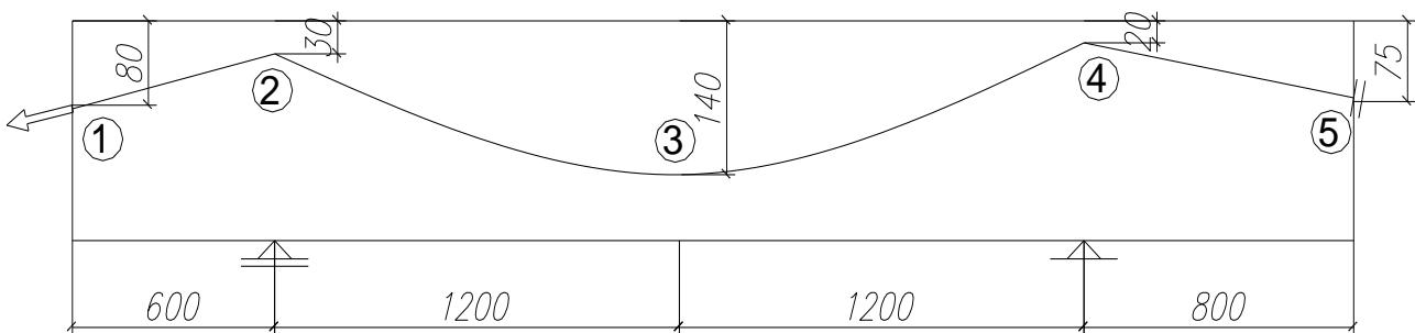
3. Za prikazani nosač i trasu rezultantnog kabla sračunati ekvivalentno opterećenje i nacrtati dijagrame presečnih sila  $M$ ,  $V (=T)$ ,  $N$  samo od uticaja PN. Sile u kablovima su  $P_1 = 5000$  kN i  $P_2 = 3500$  kN. Prikazati veličine reakcija oslonaca i nacrtati i dijagram momenata ( $M$ ) samo usled reakcija. Poprečni presek je pravougaoni.
