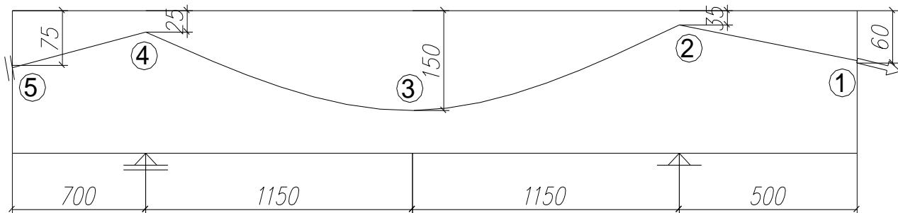
3. Za prikazani nosač i trasu rezultantnog kabla sračunati ekvivalentno opterećenje i nacrtati dijagrame presečnih sila  $M$ ,  $V (=T)$ ,  $N$  samo od uticaja PN. Sile u kablovima su  $P_1 = 5000$  kN i  $P_2 = 4500$  kN. Prikazati veličine reakcija oslonaca i nacrtati i dijagram momenata ( $M$ ) samo usled reakcija. Poprečni presek je pravougaoni.
