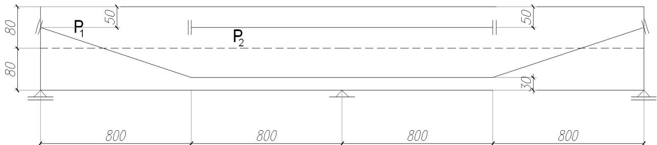
4. Za prikazani presek od betona MB40 sračunati graničnu nosivost na savijanje (moment 'loma'). Dilatacija čelika za PN pri dekomprimaciji iznosi 4,8 %. Koristiti dijagram parabola-prava za beton prema PBAB '87. Obavezno uračunati prikazanu zategnutu armaturu (RA 400/500). Pritisnuta armatura ima zanemarljivu površinu.
