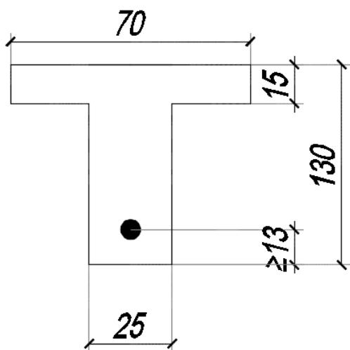
5. Montažna greda sa prikazanim konstantnim presekom ima raspon od 18.0 m. Nakon montaže nanosi se dodatni teret  $\Delta g = 8 \text{ kN/m}^2$ . Povremeni teret je  $p = 20 \text{ kN/m}$ .
