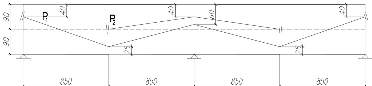
3. Za prikazani kabl koji se uteže sa desnog kraja, sračunati promenu sile (gubitke) usled trenja (odrediti veličinu sile u obeleženim tačkama 1-6). Parametri trenja su  $0.35 \text{ 1/rad}$  i  $2.0 \times 10^{-3} \text{ 1/m}$ . Sila na presi iznosi  $P^0 = 5800 \text{ kN}$ .
