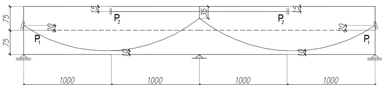
3. Sračunati ugib u sredini raspona u  $t \rightarrow \infty$  prikazanog prethodno napregnutog nosača pri delovanju naznačenog opterećenja. Sila u kablu je  $P_0 = N_{ko} = 4500$  kN,  $\eta = \omega = 0.80$ ,  $\varphi(t, t_0) = 2.6$ ,  $\varphi(t, t_1) = 1.9$  MB50, g je sopstvena težina – prema preseku,  $\Delta g = 18.0$  kN/m' ( $\Delta g$  počinje da deluje od  $t_1$ ),  $P = 400$  kN (povremeno opterećenje). Poprečni presek je pravougaoni  $30 \times 170$  cm.
