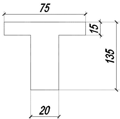
5. Montažna greda sa prikazanim konstantnim presekom ima raspon od 18.0 m. Nakon montaže nanosi se dodatni teret  $\Delta g = 10 \text{ kN/m}'$ . Povremeni teret je  $p = 12 \text{ kN/m}'$ .
