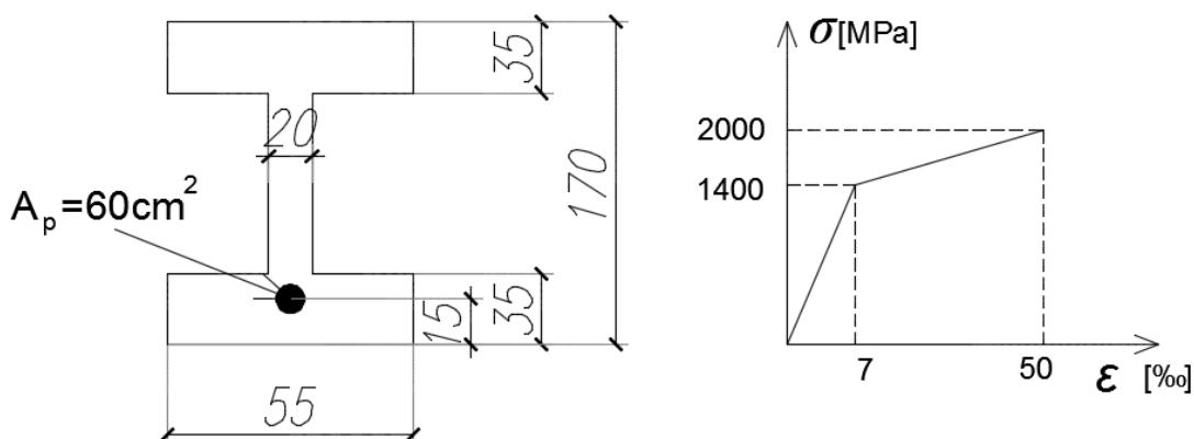
5. Sračunati ugib na kraju konzole u  $t \rightarrow \infty$  prikazanog prethodno napregnutog nosača pri delovanju naznačenog opterećenja. Sila u kablu je  $P_0 = N_{k0} = 5000$  kN,  $\eta = \omega = 0.84$ ,  $\varphi(t, t_0) = 2.5$ ,  $\varphi(t, t_1) = 2.1$ , MB50,  $g$  je sopstvena težina – prema preseku,  $\Delta g = 14.0$  kN/m' ( $\Delta g$  počinje da deluje od  $t_1$ ),  $P = 250$  kN (povremeno opterećenje). Poprečni presek je pravougaoni  $35 \times 180$  cm.
