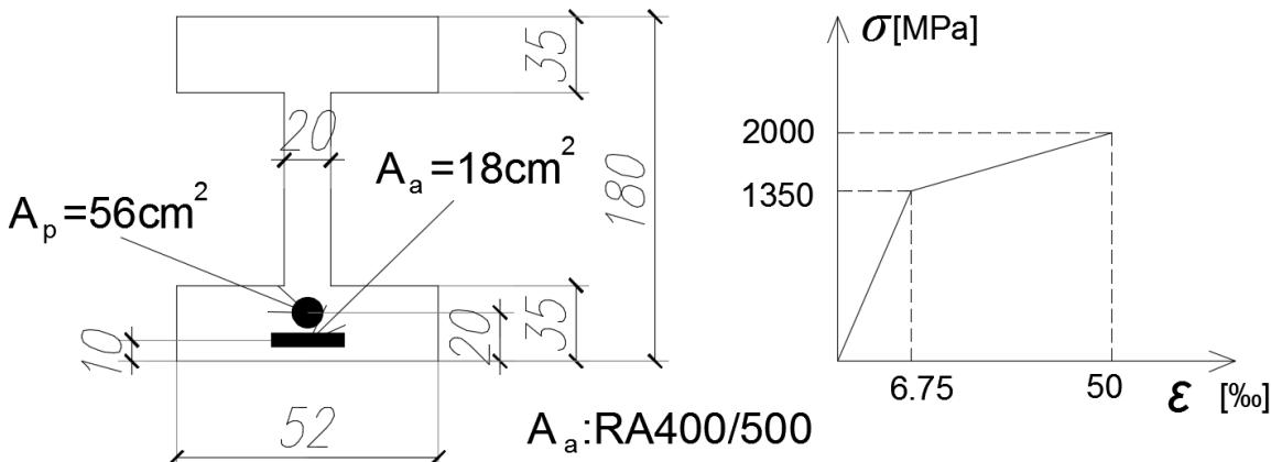
4. Za prikazani nosač i trasu resultantnog kabla sračunati ekvivalentno opterećenje i nacrtati dijagrame presečnih sila  $M$ ,  $V (=T)$ ,  $N$  samo od uticaja PN. Sile u kablovima su  $P_1 = 5000 \text{ kN}$  i  $P_2 = 4000 \text{ kN}$ . Prikazati veličine reakcija oslonaca i nacrtati i dijagram momenata ( $M$ ) samo usled reakcija. Poprečni presek je pravougaoni.
