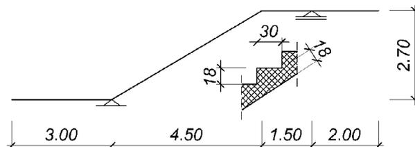
2. Sračunati statičke uticaje, dimenzionisati i skicirati plan armature stepeništa u podužnom preseku, statičkog sistema datog na skici. Korisno opterećenje,  $p = 3.0 \text{ kN/m}^2$ . Korisno opterećenje može delovati u proizvoljnom položaju.
