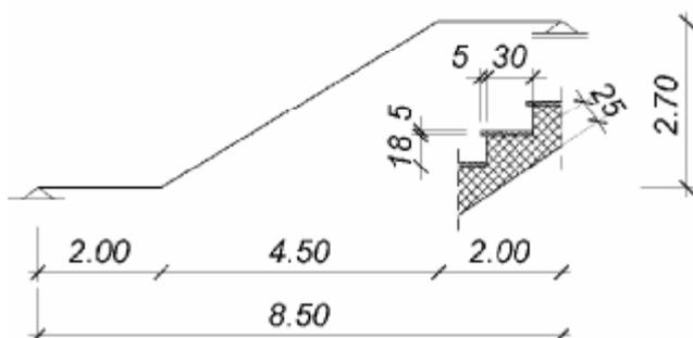
3. Sračunati statičke uticaje, dimenzionisati i skicirati plan armature stepeništa u podužnom preseku, statičkog sistema datog na skici.
