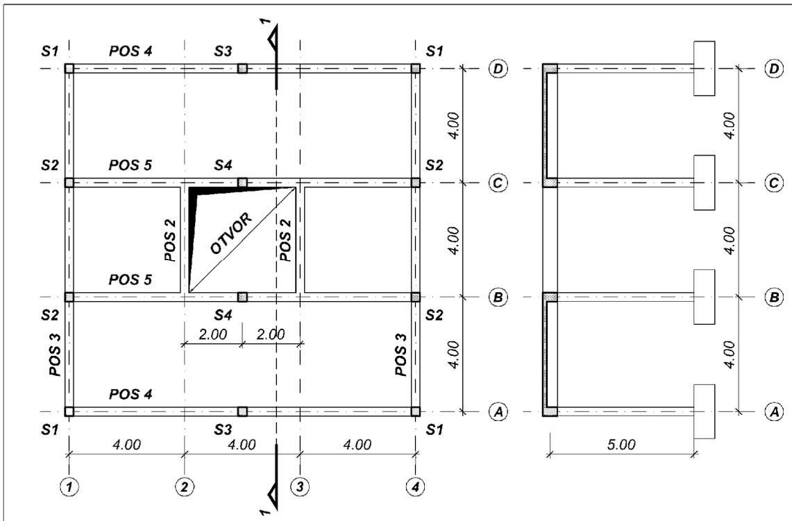
1. Konstrukcija prikazana na skici 1, pored sopstvene težine elemenata, opterećena je i dodatnim stalnim opterećenjem  $\Delta g = 2.0 \text{ kN/m}^2$ , kao i povremenim opterećenjem,  $p = 3.0 \text{ kN/m}^2$ . Za dejstvo totalnog opterećenja potrebno je uraditi sledeće:
