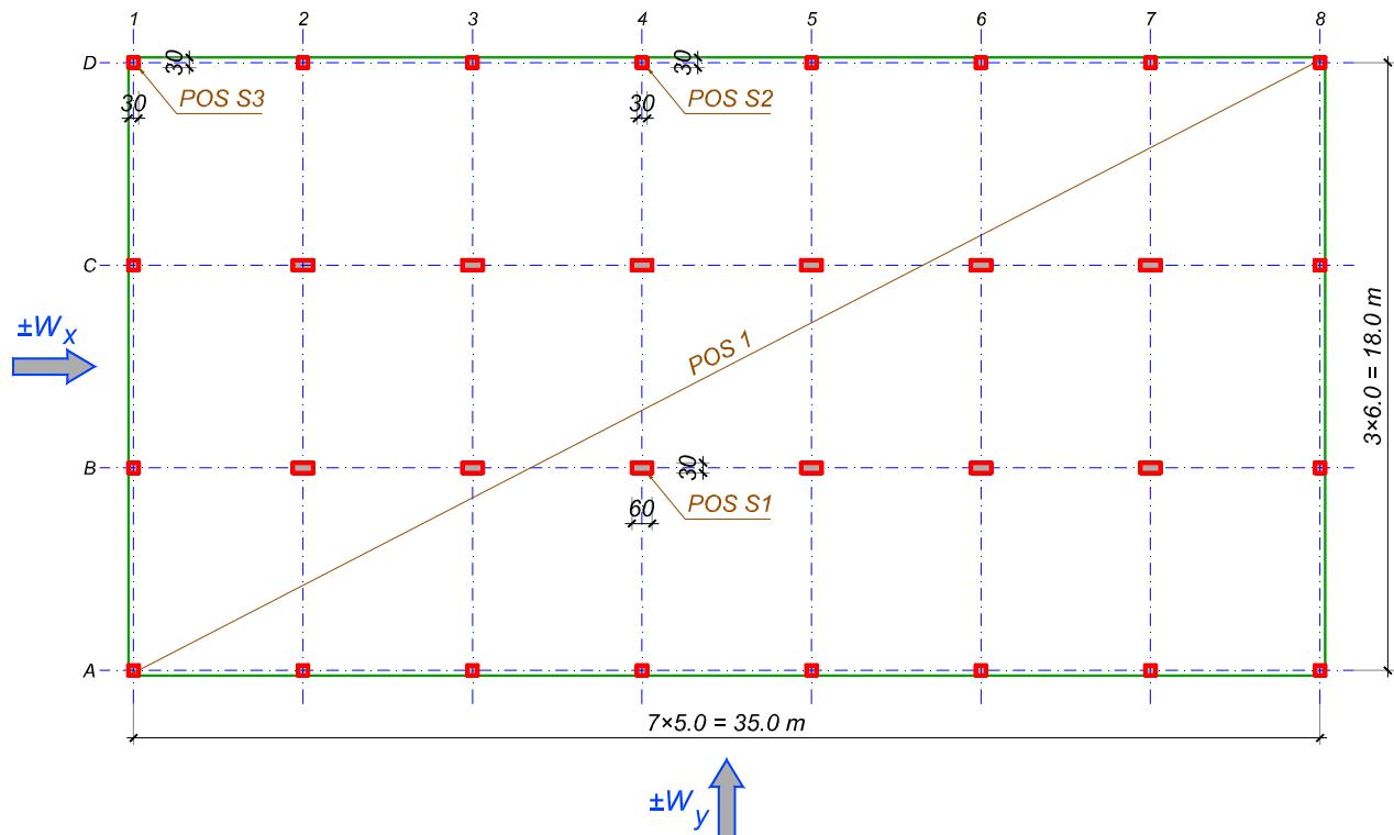
Ploča **POS 1** ( $d_p = 20 \text{ cm}$ ), opterećena je, pored sopstvene težine, povremenim opterećenjem  $\mathbf{p} = 10 \text{ kN/m}^2$  koje deluje po čitavoj površini ploče. Potrebno je:
