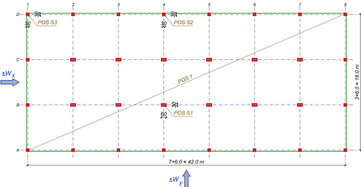
Ploča **POS 1** ( $d_p = 20 \text{ cm}$ ), opterećena je, pored sopstvene težine, dodatnim stalnim opterećenjem  $\Delta g = 2.5 \text{ kN/m}^2$  i povremenim opterećenjem  $p = 5 \text{ kN/m}^2$ , koja deluju po čitavoj površini ploče. Potrebno je:
