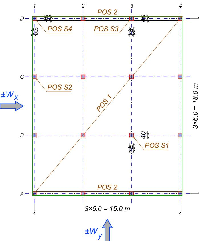
Ploča **POS 1** ( $d_p = 20 \text{ cm}$ ), opterećena je, pored sopstvene težine, dodatnim stalnim opterećenjem  $Dg = 2.5 \text{ kN/m}^2$  i povremenim opterećenjem  $p = 7.5 \text{ kN/m}^2$ . Ploča je oslonjena na stubove kvadratnog poprečnog preseka (40/40 cm), visine  $H = 4.0 \text{ m}$ . U osama A i D izvedene su AB grede **POS 2**, dimenzija 40/50 cm. Dejstvo veta na objekat je predstavljeno ukupnim silama  $\pm W_x = 360 \text{ kN}$  odnosno  $\pm W_y = 300 \text{ kN}$ . Potrebno je:
