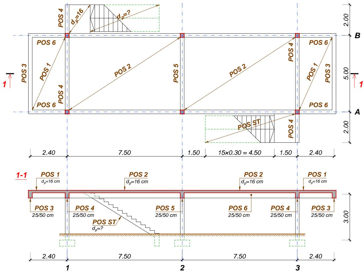
3. Izvršiti analizu opterećenja, sračunati staticke uticaje i dimenzionisati **POS 4** i **POS 6**. Sve grede su dimenzija  $25/50 \text{ cm}$ . Skicirati plan armature grede **POS 4** u približnoj razmeri (podužni presek, karakteristični poprečni preseci).
