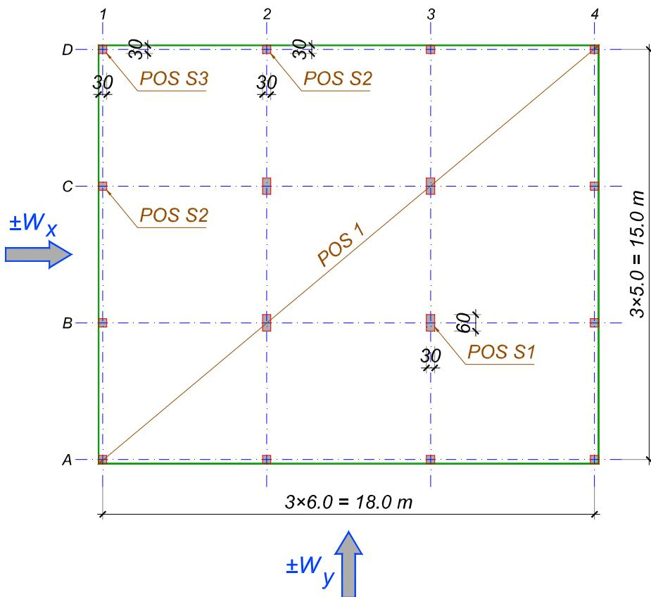
Ploča **POS 1** ( $d_p = 22 \text{ cm}$ ), opterećena je, pored sopstvene težine, dodatnim stalnim opterećenjem  $Dg = 2.0 \text{ kN/m}^2$  i povremenim opterećenjem  $p = 10 \text{ kN/m}^2$ , koja deluju po čitavoj površini ploče. Ploča je oslonjena na stubove **POS S1** (30/60 cm) i **POS S2**, **POS S3** (30/30 cm). Stubovi su visine  $H = 3.2 \text{ m}$ . Dejstvo veta na objekat je predstavljeno ukupnim silama  $\pm W_x = 225 \text{ kN}$  odnosno  $\pm W_y = 270 \text{ kN}$ . Potrebno je:
