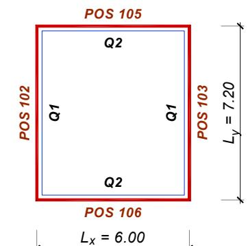
Jednako raspodeljeno opterećenje koje se sa ploče prenosi na pojedine grede, posebno za stalno, odnosno povremeno opterećenje, prikazano je na donjoj šemi. Stalnom opterećenju potrebno je dodati sopstvenu težinu greda.
