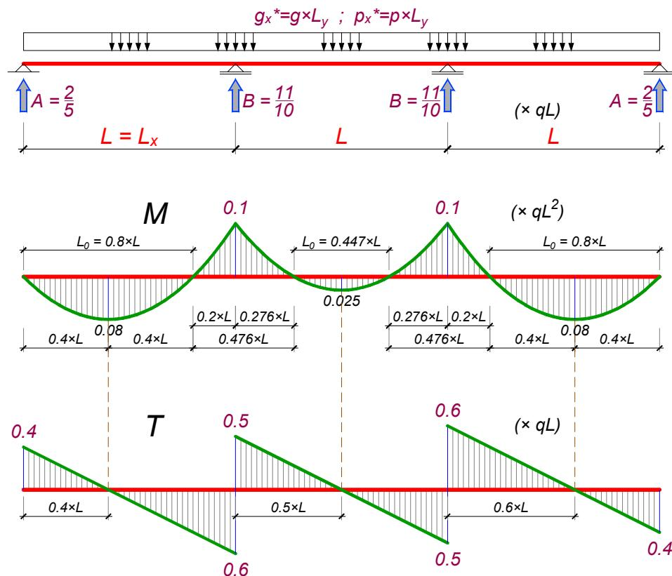
Ukupne vrednosti momenata savijanja za nosač širine  $L_y = 5.0 \text{ m}$  usled stalnog, povremenog i graničnog ( $1.6 \times g + 1.8 \times p$ ) opterećenja su prikazani tabelarno.
