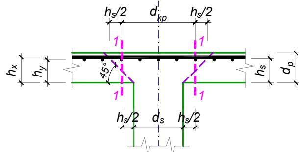
kao prečnik ekvivalentnog kružnog stuba. U proračun zamenjujućeg prečnika  $d_s$  može se uzeti maksimalno  $d=1.5 \times b$  ( $b < d$ ), bez obzira na stvarni odnos strana pravougaonog stuba;
