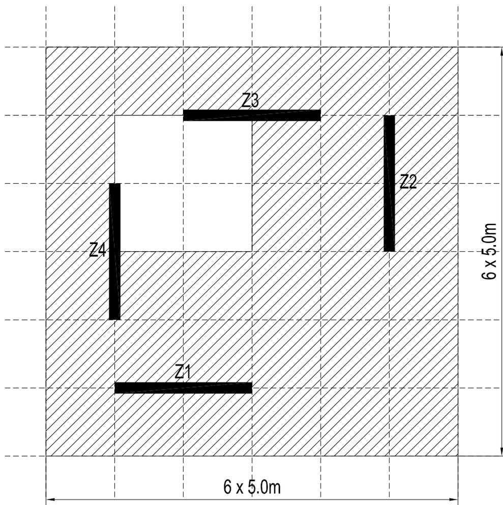
Uraditi idejno rešenje armiranobetonske konstrukcije poslovne zgrade. Osnova tipskog sprata sa otvorom za atrijum u ploči i rasporedom zidova Z1-Z4 data je na skici. Spratna visina iznosi  $h = 3.20\text{m}$ , a ukupna visina konstrukcije od kote uklještenja iznosi  $H = 8 \times 3.20 = 25.6\text{m}$  (prizemlje + 7 spratova).
