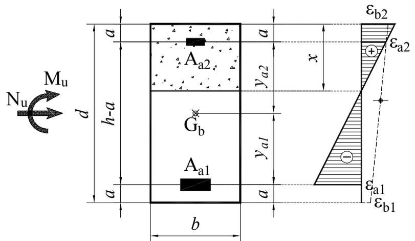
Na skici desno je prikazan poprečni presek i označene potrebne geometrijske veličine. Pri određivanju bezdimenzionih koeficijenata usvojeno je da su **pozitivni** moment savijanja koji zateže **donju** ivicu nosača i normalna sila **pritiska**. Uvode se sledeće oznake:
