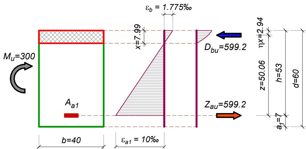
Zavisnost računski potrebne površine armature  $A_a$  od širine poprečnog preseka i kvaliteta betona prikazana je na narednim dijagramima ( $M_u = 300 \text{ kNm}$ ,  $d = 60 \text{ cm}$ ,  $h = 53 \text{ cm}$ ).
