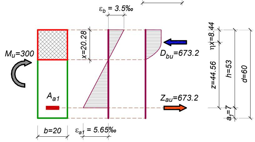
**P4.** Dimenzionisati gredni nosač iz primjera P1, ukoliko je izveden od betona MB 50
