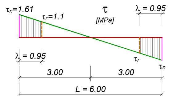
za određivanje dužine osiguranja, već je potrebno naći dužinu dela nosača na kome je napon  $\tau_n$  veći od čvrstoće  $\tau_r$ .
