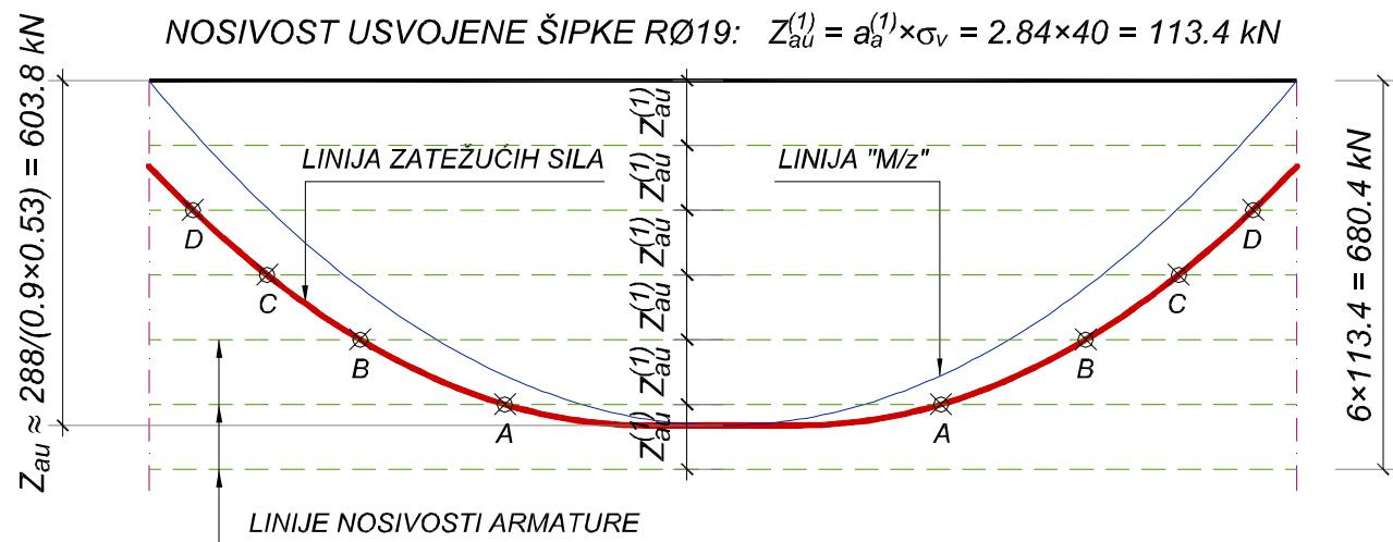
Presečne tačke linije zatežućih sila (potrebna armatura) sa linijama nosivosti (usvojena armatura) označene su slovima A do D. Može se uočiti da je između tačaka D potrebno više od  $2R\ Ø 19$ , između tačaka C više od  $3R\ Ø 19$ , između tačaka B više od  $4R\ Ø 19$  i između tačaka A više od  $5R\ Ø 19$ . Ove staticke zahteve potrebno je uklopiti sa konkretnim rasporedom armature u preseku i na logičan način ukidati pojedine šipke, vodeći računa da:
