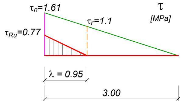
**Redukovani napon smicanja  $\tau_{Ru}$  nema potrebe upoređivati sa računskom čvrstoćom  $\tau_r$ .**
